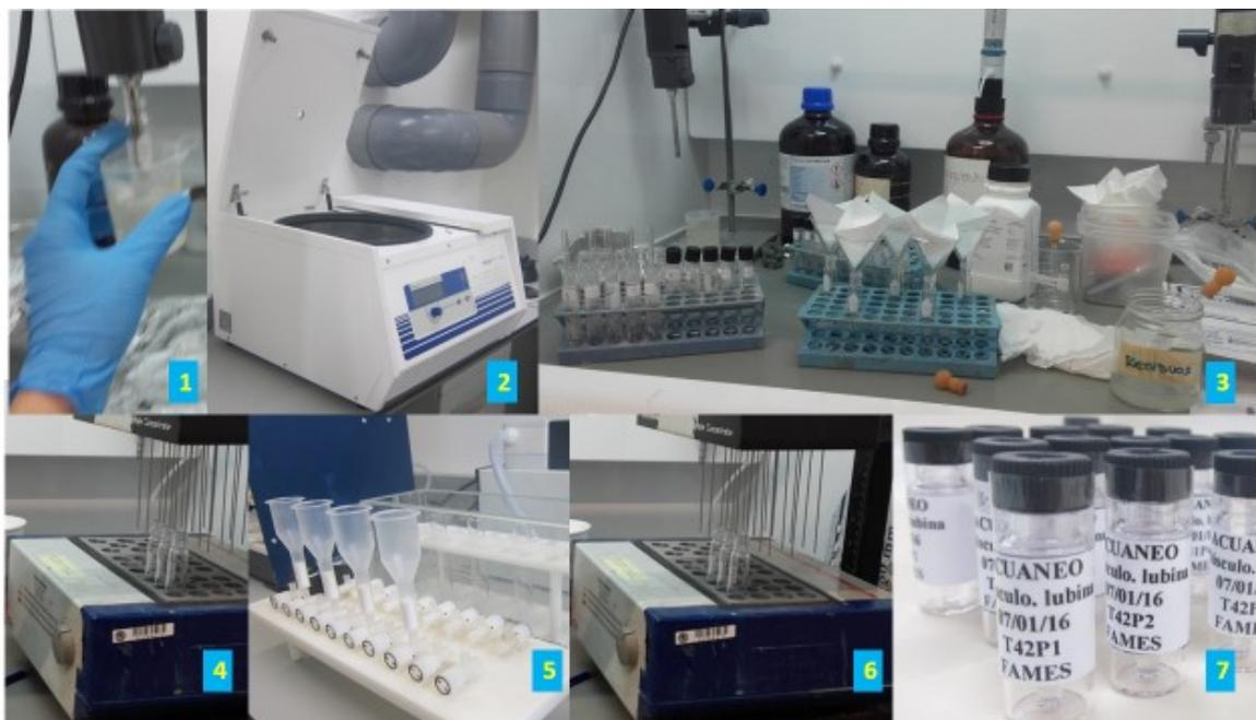
Figura 12: Metodología para la cuantificación del contenido en lípidos y ácidos grasos. 1, 2, 3 y 4 (pasos y aparatos de la extracción de lípidos), 5, 6 y 7 (metilación para determinar los FAMES).
