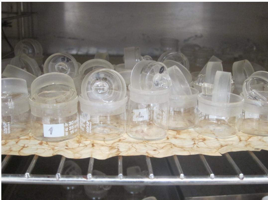
Figura 13: Pesafiltros utilizados para determinación de la humedad en las dietas.
