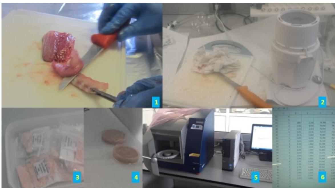
Figura 22: Procesamiento de las lubinas sacrificadas. 1 (limpieza de los filetes), 2 (picadora de cocina), 3 (almacenamiento del puré de la homogeneización), 4 (placas Petri usadas para el NIR), 5 (NIR) y 6 (base de datos).
