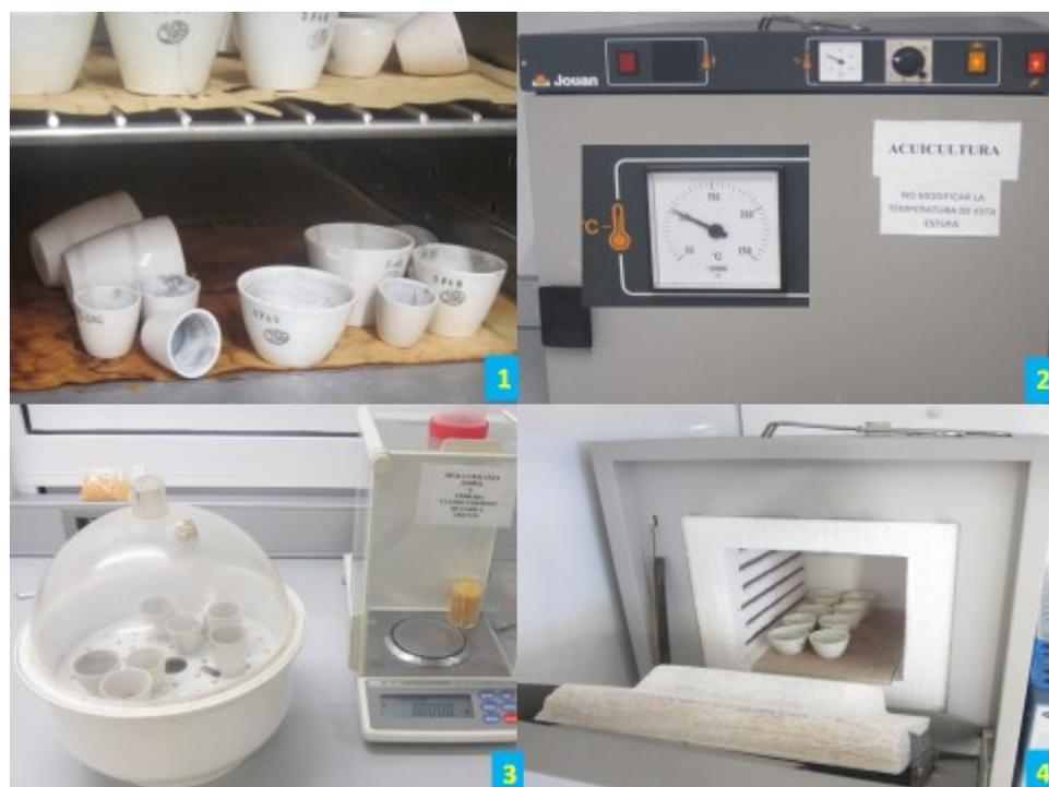
Figura 23: Determinación de cenizas. 1 (crisoles), 2 (estufa), 3 (desecador y balanza) y 4 (mufla 600°C).
