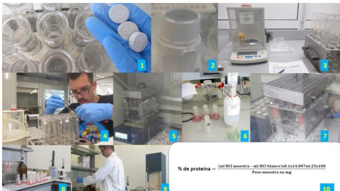
Figura 14: Metodología para la determinación de proteínas. 1 (catalizador de cobre y selenio), 2 (picador de cocina), 3 (anotación de pesos analizados), 4 (incorporación de las dietas pesadas en los respectivos tubos), 5 (digestión ácida), 6 (valoración ácido clorhídrico), 7 (enfriamiento tras las digestión ácida), 8 (incorporación de ácido bórico e indicador mixto 4,8), 9 (destilador Kjeltect™ 2100 de la marca FOSS) y 10 (fórmula de % de proteína).
