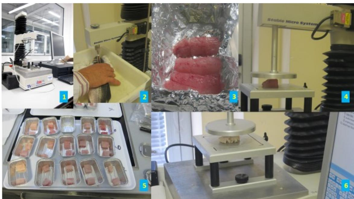
Figura 20: Texturómetro y toma de texturas. 1 (texturómetro), 2 (toma de textura pez entero), 3 (porciones filete crudas), 4 (toma de textura del filete en crudo), 5 (porciones del filete cocinadas) y 6 (toma de textura del filete cocinado).
