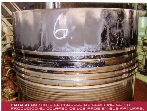
FOTO 3: DURANTE EL PROCESO DE SCUFFING SE HA PRODUCIDO EL COLAPSO DE LOS AROS EN SUS RANURAS.
