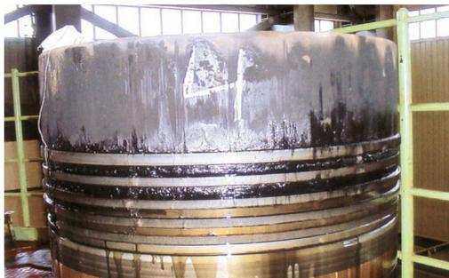
FOTO 2: CABEZA PISTÓN TRAS PROCESO SCUFFING. SE OBSERVAN RESTOS DE CENIZAS EN CORONA DE Y PASO DE RESIDUOS DE COMBUSTIÓN POR DERRAJO DEL ARO.
