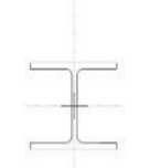
CRUCES DE SAN ANDRÉS Perfil HEB 160 mm ST. ANDRÉS CROSS HEB profile 160 mm
