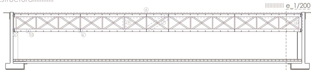
6 Vigas principales -perfil IPN 360\_ 7 Vigas de rigidización -perfil IPN 160\_ 9 perfil IPN 100\_ 10 Viguetas forjado perfil IPN 80 6 Vigas de atado -perfil IPN 360
