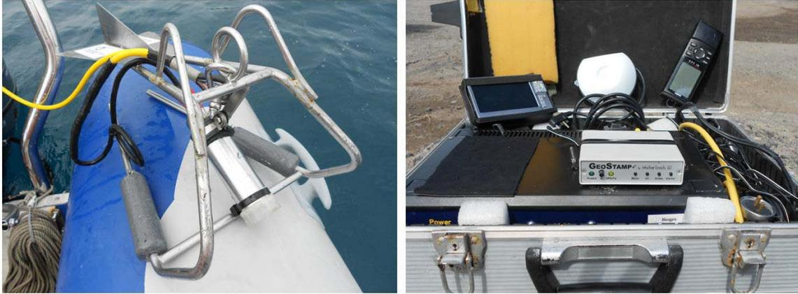
*Figura 5. Izquierda: cámara de vídeo MARISCOPE. Derecha: monitor de televisión, GEOSTAMP, GPS Garmin 12 y fuente de alimentación de la cámara.*
