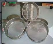
18 tamis composent la colonne de tamisage (de 16 mm, gravier, à 45 microns, limon).
