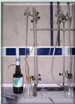
La mesure du pourcentage des carbonates ( $\text{CaCO}_3$ ) ou Méthode Calcimétrie dans le sol ou les sédiments est basé sur la détermination gazométriques de  $\text{CO}_2$
