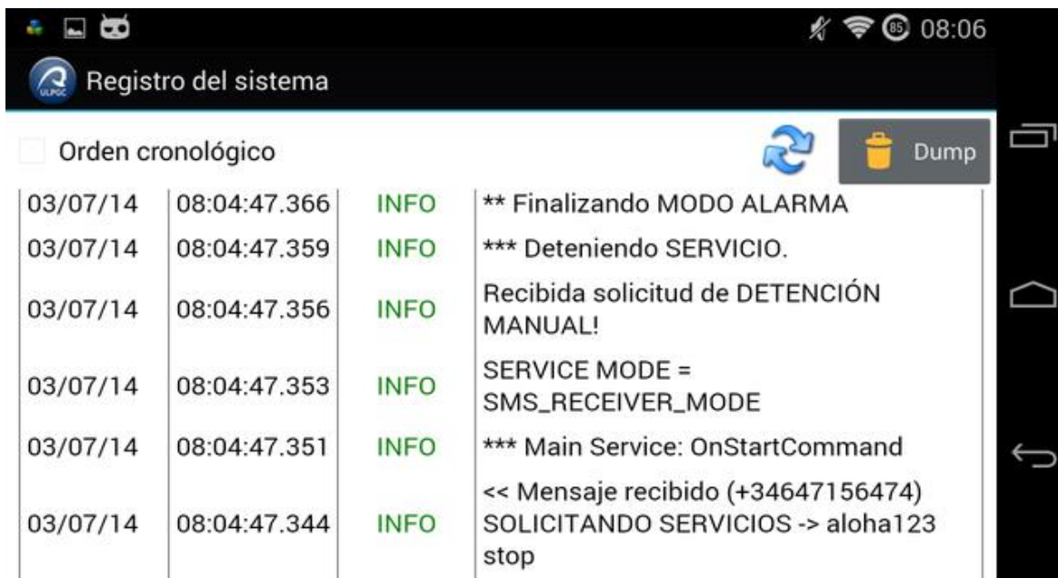
Figura 5.19. El registro del sistema. Respuesta al cuarto ejemplo ejecutada con éxito.
