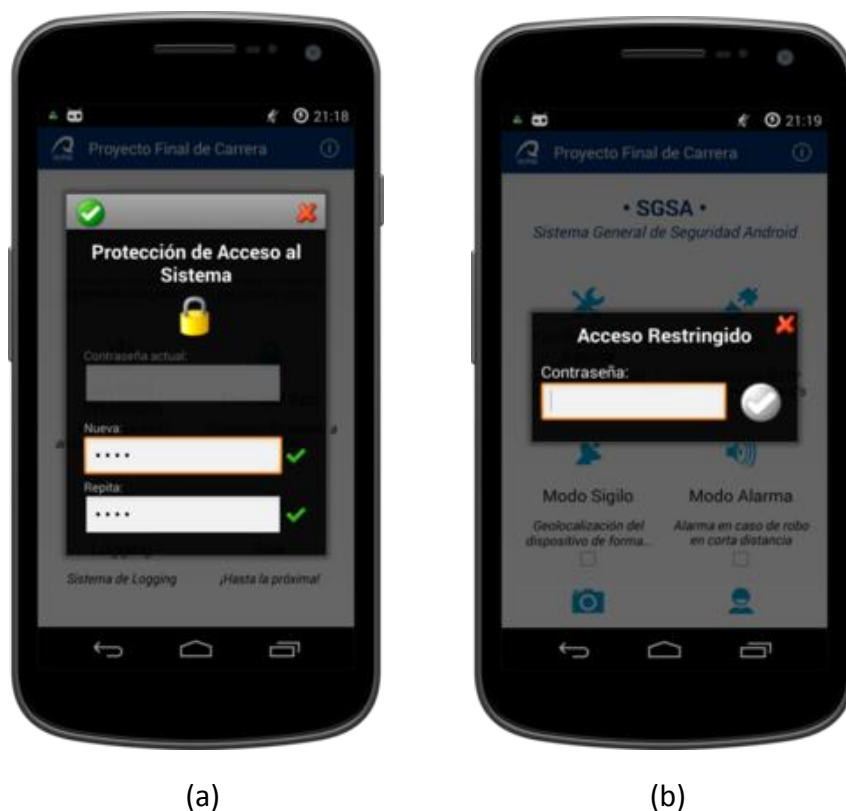
Figura 5.12. Protección del sistema. (a) Definiendo una clave de protección y activando el módulo. (b) Solicitud de contraseña.
