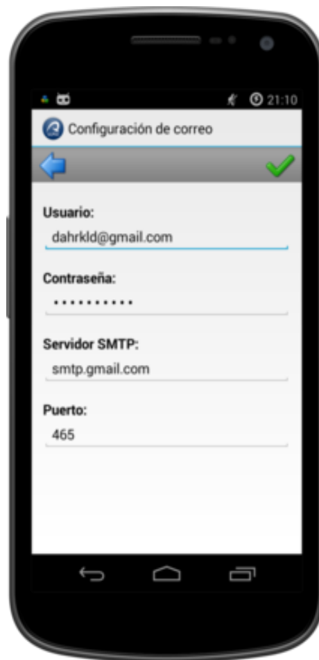
Figura 5.5. Configuración del servidor SMTP para el envío de correo electrónico.
