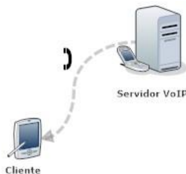
Figura 4.19. Flujo de datos de VoIP en sentido servidor-cliente
