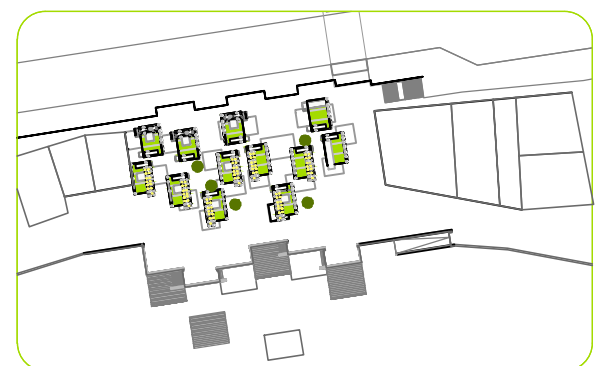
FASE 4 COLOCACIÓN DE LOS MÓDULOS PREFABRICADOS DE LA PLANTA ALTA
