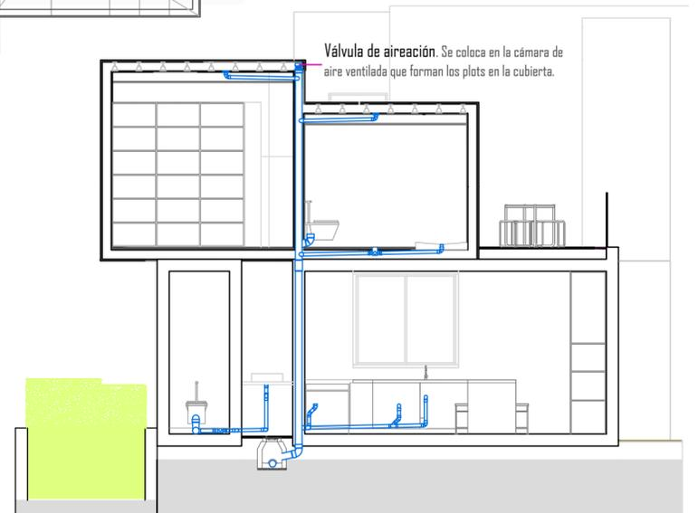
Válvula de aireación. Se coloca en la cámara de aire ventilada que forman los plots en la cubierta.
