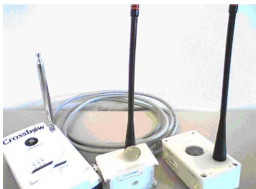
Algunos elementos (gateway y motes) del kit medioambiental de XBow
