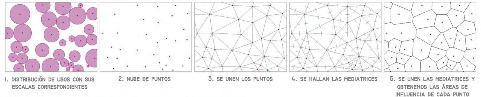
OBTENCIÓN DE LA GEOMETRÍA MEDIANTE EL MÉTODO VORONOI
