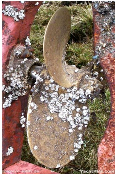
Fig. 3. Invasión de macro-fouling de una hélice de barco. En <http://www.YachtPats.com>.
