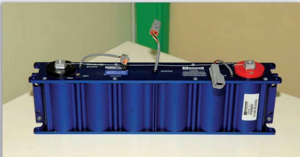
Figura 4. Módulo de supercondensadores
