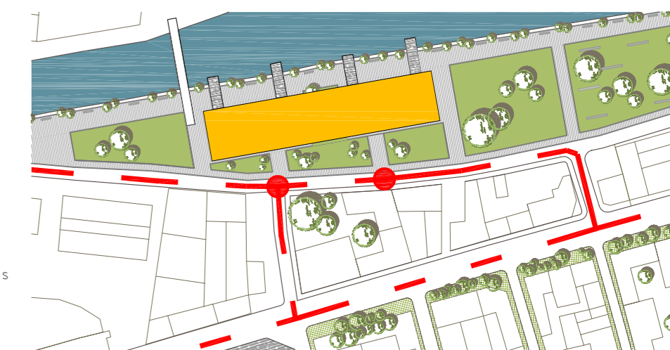
INTERVENCION DE LOS BOMBEROS Vias de acceso bomberos, la distancia entre la via y el edificio esta entre 20-25mt.
