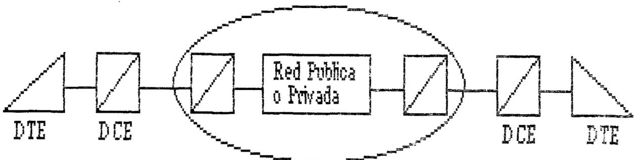
Figura 2. Conexión a través de Red de Transmisión de Datos.
