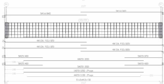
A) Viga de canto, 15m de luz. Forjado del espacio escénico. losa maciza de 30 cm de espesor
