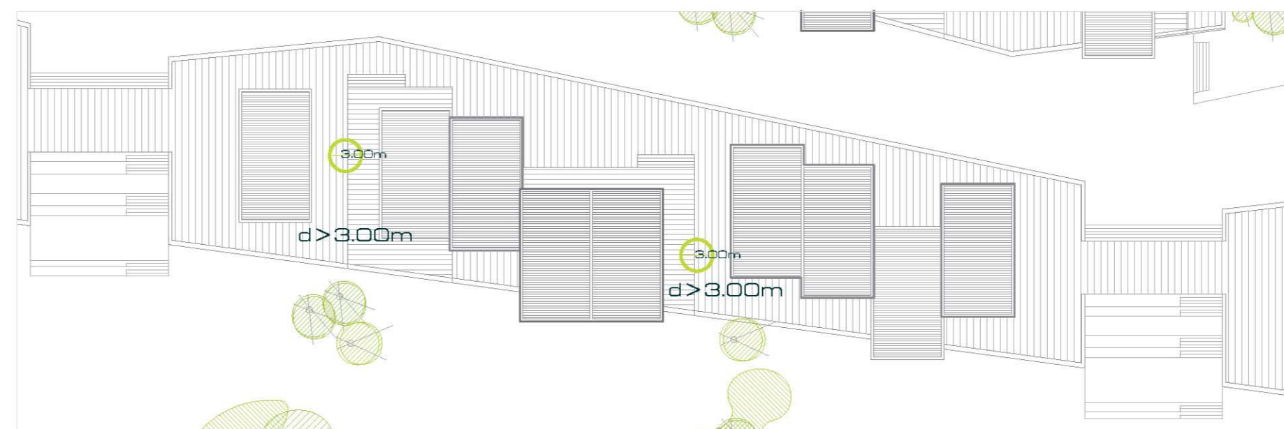
distancia d que deben estar separadas las fachadas que NO sean al menos EI 60 e: 1/500
