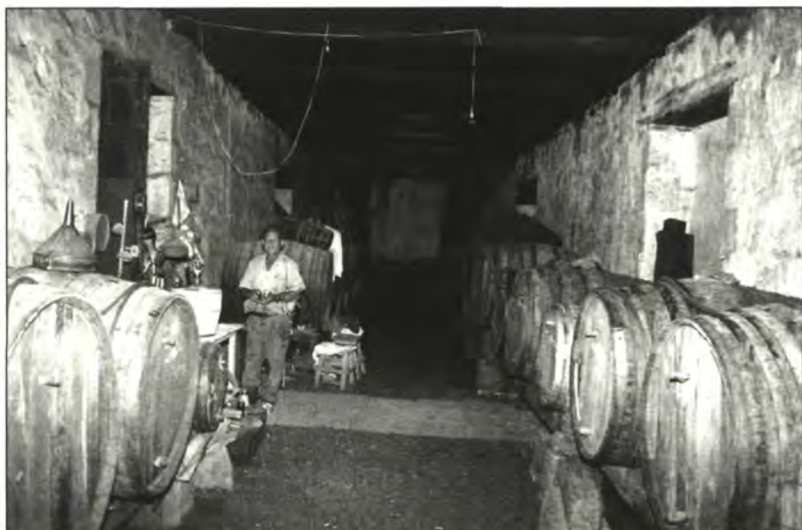
Interior de bodega con suelo de picón, techumbre de madera y toneles sobre los canteros.
