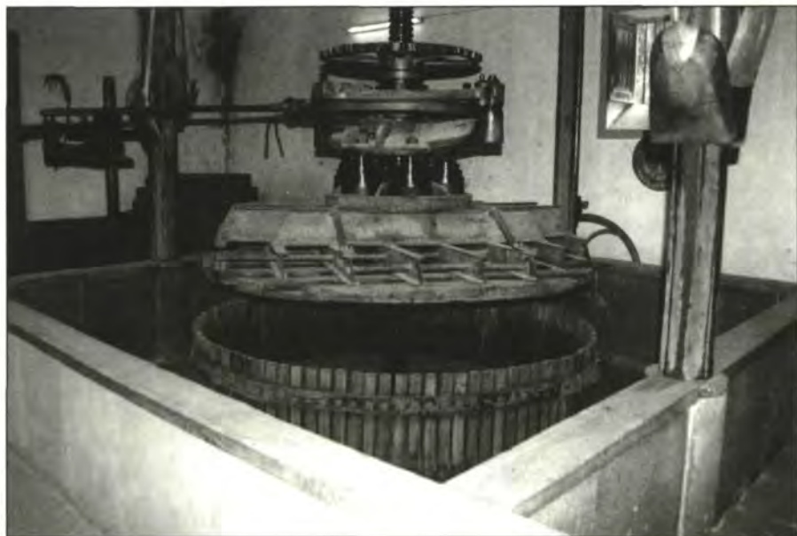
Prensa de hierro de presión continua de la Bodega de San Juan.
