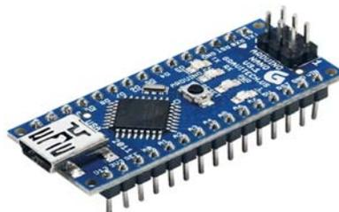
Figura 3. Microcontrolador ATmega 328P (Atmel). Arduino Nano R3.
