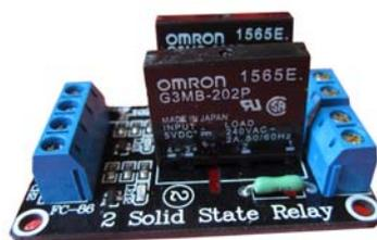
Figura 4. Réle de estado sólido Omrom G3MB.
