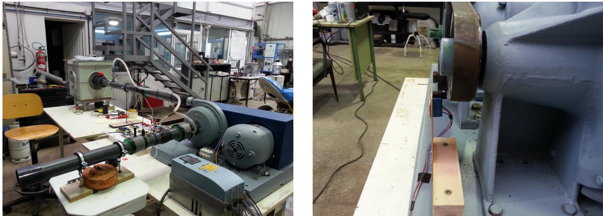
Figura 3. Fotografías del banco de pruebas desarrollado. **Izquierda:** Instalación, con los elementos indicados en el esquema. **Derecha:** Fotografía del tacómetro óptico desarrollado, ubicado frente a la polea de la soplante.
