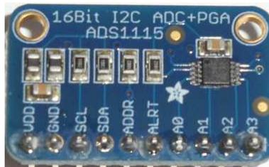
Figura 2. Convertidor analógico-digital ADS1115.
