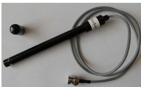
Figura 2. Sonda de conductividad eléctrica.
