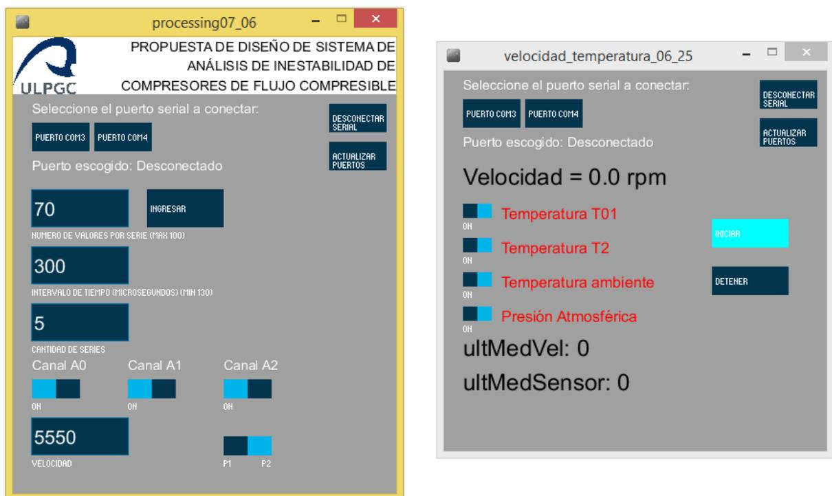
Figura 6. Interfaz creada en *Processing* para el control del sistema de adquisición de datos del banco de pruebas desarrollado. **Izquierda:** Interfaz para captura de datos a alta velocidad. **Derecha:** Interfaz para captura a baja velocidad.
