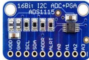
Figura 2. Conversor analógico-digital, ADS1115.
