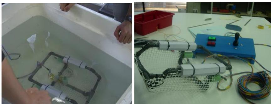
Fig. 4 Ajuste de la flotabilidad del vehículo submarino. (a) Vehículo en la cubeta de pruebas. (b) Vehículo con los flotadores ajustados al chasis.
