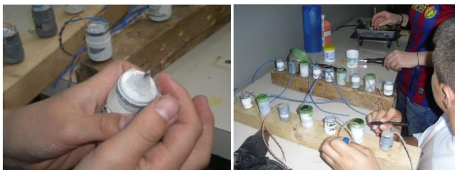
Fig. 3. Sellado de los motores de corriente continua. (a) Vaselina en el eje del motor. (b) Sellado del conjunto con cola térmica.
