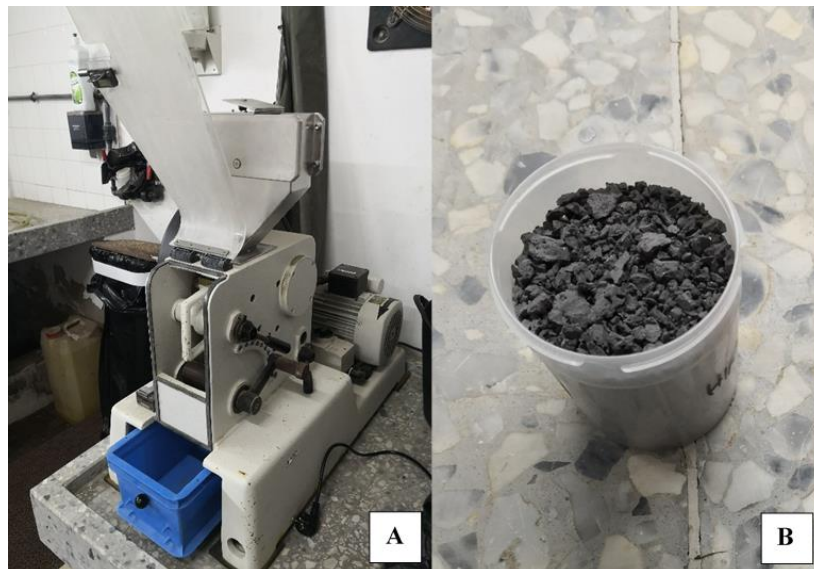
Figura 1.6. A) Imagen de la machacadora del taller de Geología. B) Ejemplo del resultado de la muestra una vez machacados los tacos de roca.
