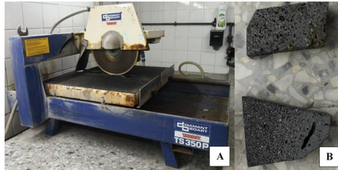
Figura 1.5. A) Imagen de la sierra operativa en el taller de Geología. B) Ejemplos de tacos de la muestra de roca de la lava del Pico de Bandama.
