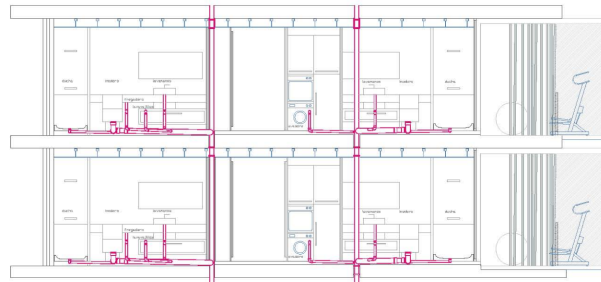
DETALLE EN SECCIÓN-DISTRIBUCIÓN DESAGÜES EN VIVIENDA
