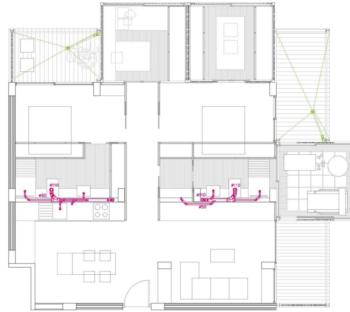
Detalle en planta-distribución desagües en vivienda
