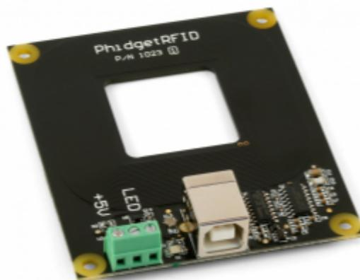
Img. 12: Módulo PhidgetRFID
