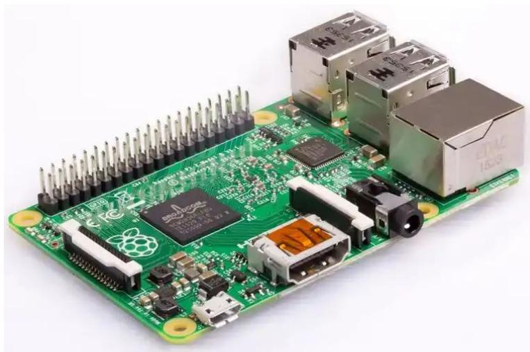
Img. 9: Módulo Raspberry Pi v2
