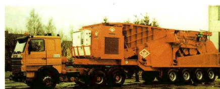
Instalación móvil de trituración de escombros
