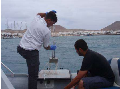
FIGURA 4. Toma de muestras arenosas submareales con la draga Van Veen frente al puerto de Caleta del Sebo.
