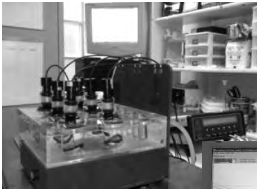
Foto 3. Izquierda: Incubación en botellas donde la concentración de O_2 es monitorizada por un oxímetro. Abajo: Las pendientes de las muestras corregidas por las botellas control reflejan la tasa respiratoria de los organismos.
