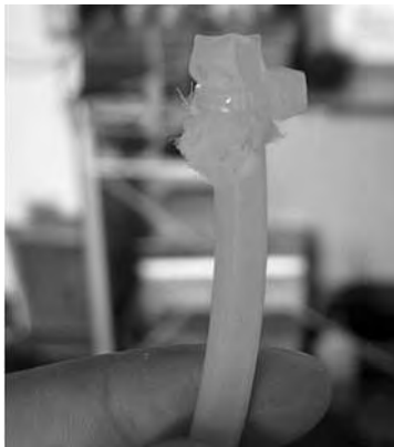
Foto 4. Sifón para extracción de NH_4^+ con malla de 100 \mu m en el extremo.
