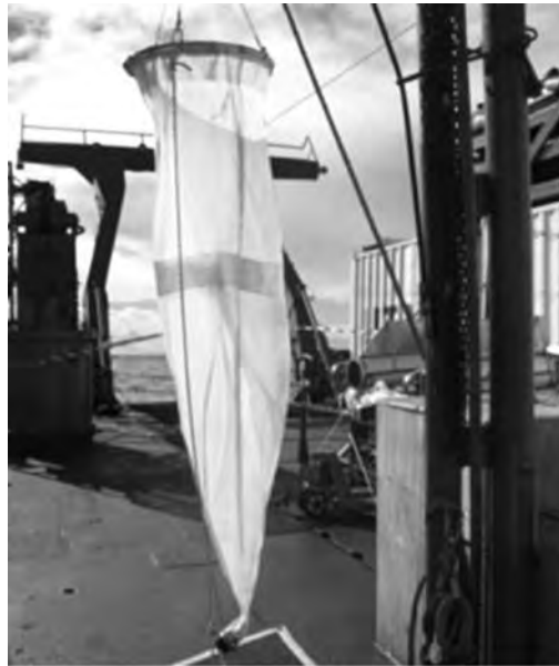
Foto 1. Red WP-2 (100 \mu\text{m} ) utilizada en la recogida de muestras.
