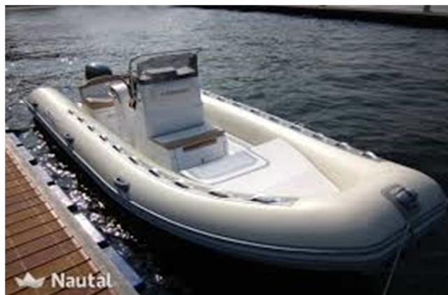
Figura 1. Embarcación neumática semi-rígida tipo zodiac.
