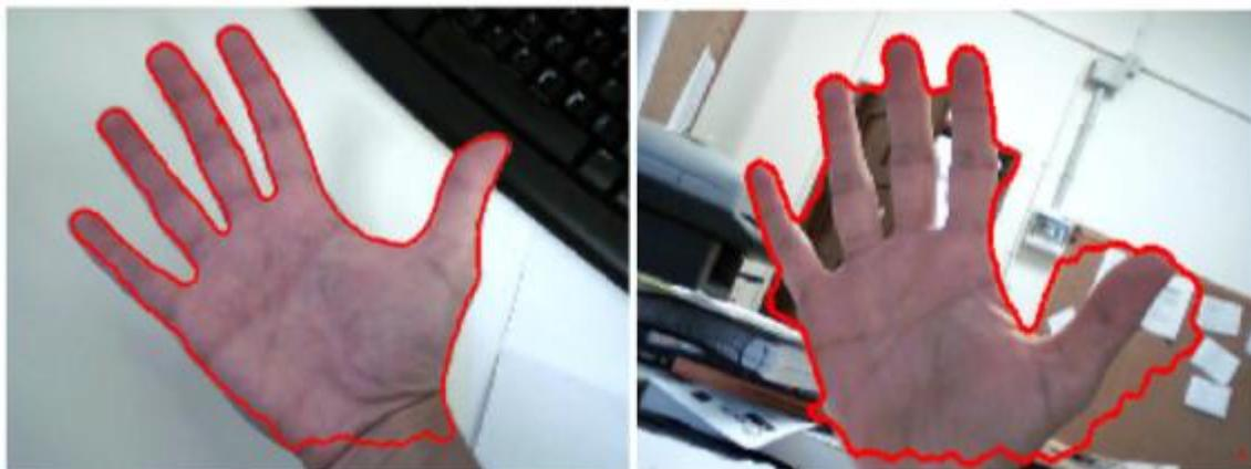
Figura 3.10. Detección de bordes de la palma de la mano por el método “level-set”
