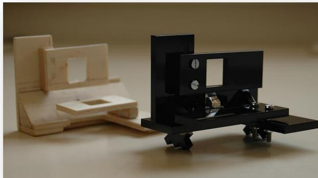
**Figura 4.5. Prototipo en madera de balsa y prototipo en metacrilato del soporte de dispositivos para el sistema de correlación con filtro dicroico**
