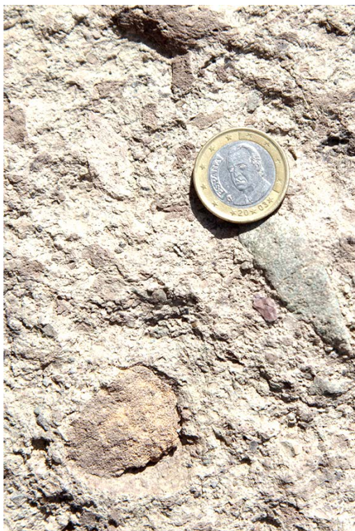
Figura 7.11 F1 Ignimbrita fonolítica de bloques y ceniza, soldada.
