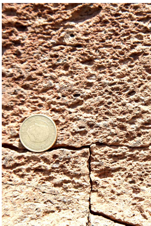
Figura 7.9 TR4 Ignimbrita traquítica-riolítica soldada de pómez y ceniza.
