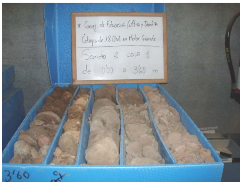
Figura 7.13 Sondeo en depósitos sedimentarios del barranco en Motor Grande. Fuente: Geotecan
