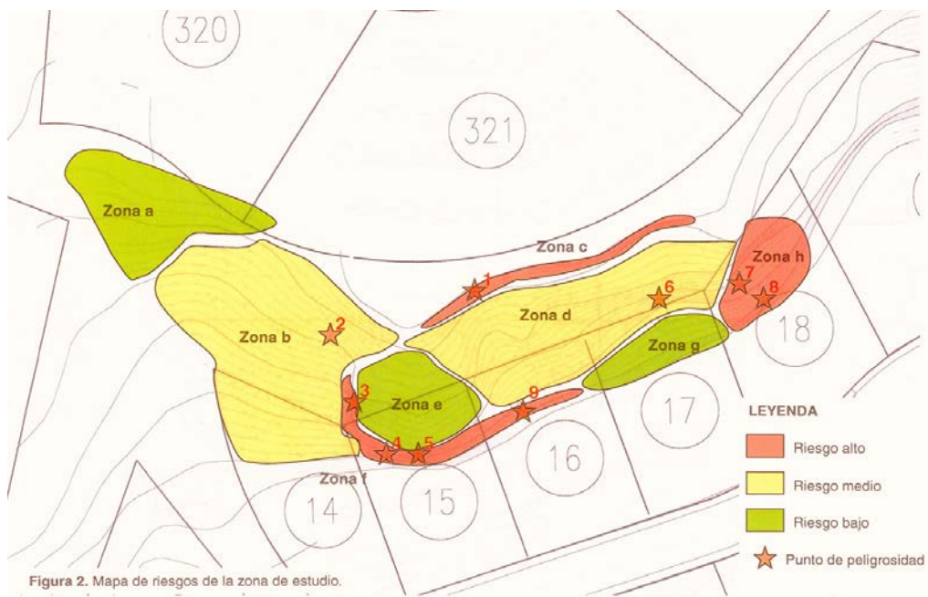
Figura 7.30 Mapa de riesgos de estudio geotécnico realizado para la parcela D207, en Agua de la Perra. (Lomoschitz y Cilleros, 2006)
