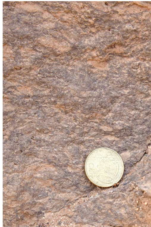
Figura 7.6 TR1A: Ignimbrita traquítica-riolítica soldada con pocos líticos, alterada.
