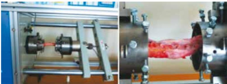
Figura 21. Ensayo de torsión en fémur ovino.
