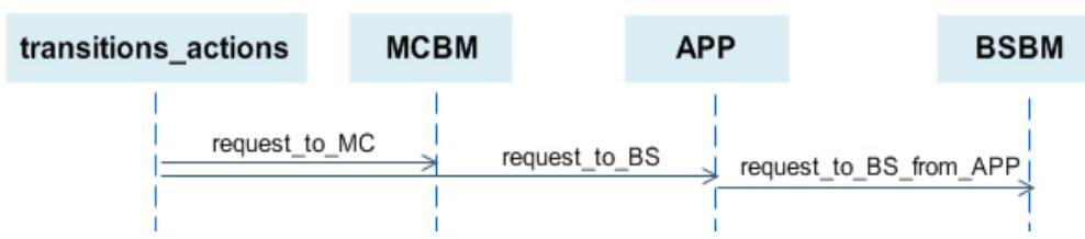
Figura 7.17: Señales generadas por el proceso *transitions\_actions*
