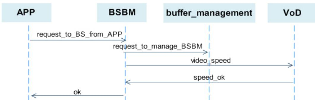
Figura 7.18: El intercambio de señales para controlar la velocidad de transmisión de vídeo
