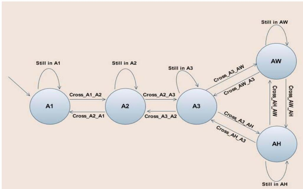
Figura 7.15: Diagrama del estado para los transiciones del MC
