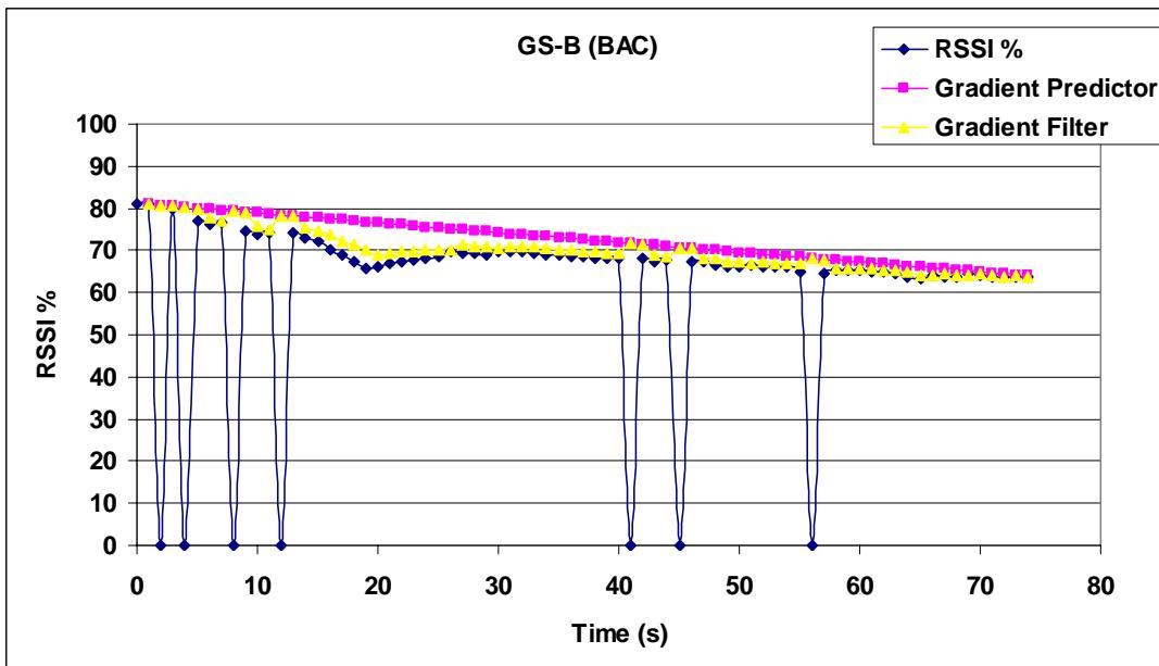
Figura 7.14: Prueba del Filtro Gradiente en valores medidas de RSSI en la dirección GS-B (BAC)
