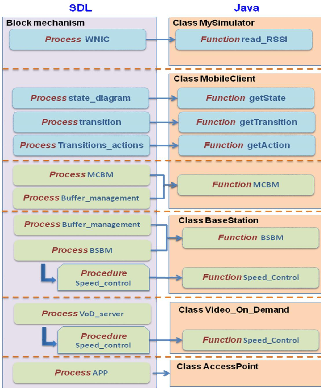
Figura 7.19: Derivación del simulador a partir de la especificación SDL
