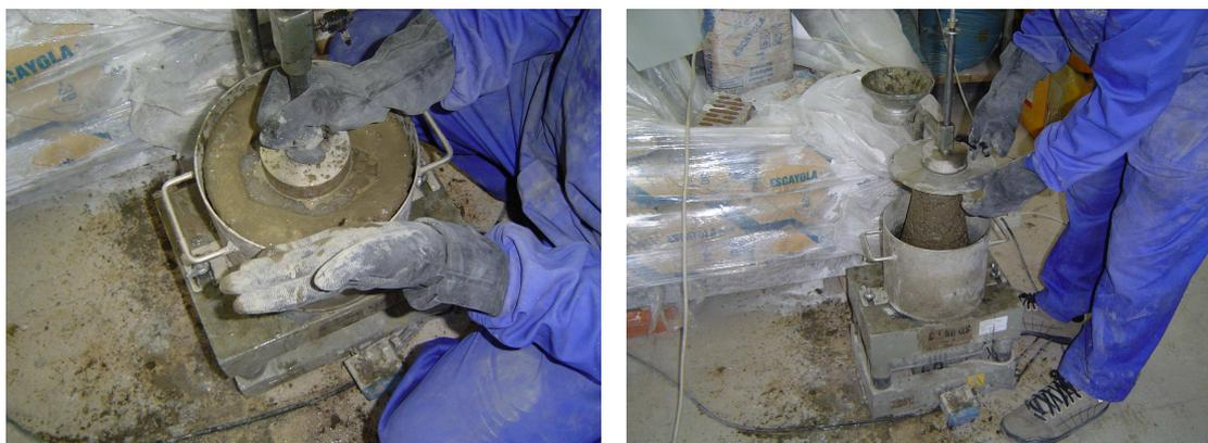
*Figura 2.8. Vista de ensayo realizado en laboratorio de medida de consistencia mediante consistómetro Vebe en hormigón con fibra.*
