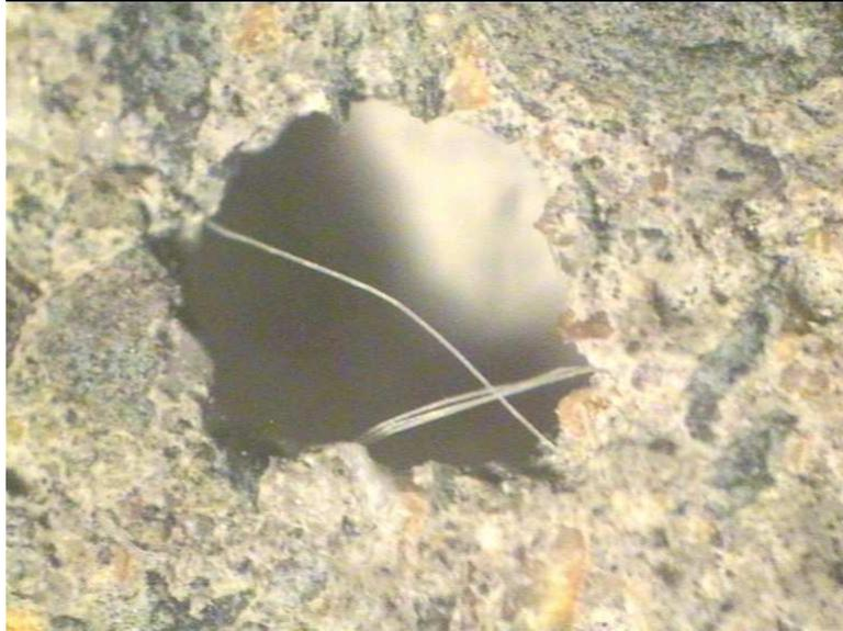
*Fig. 3.78. Imagen mediante microscopio óptico de 200x de cara de probeta de Hormigón tipo con 0,099% de F.P.; 10% H.S. y A/C 0,60 (H.S.F.1-900).*
