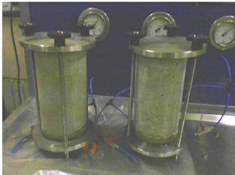
*Fig. 3.60 Imagen de máquina de ensayos para penetración de agua de PAS (Pavimentos Asfálticos Salamanca), vista cercana de cánulas de fijación para probetas cilíndricas de 15x30 cm<sup>2</sup>.*
