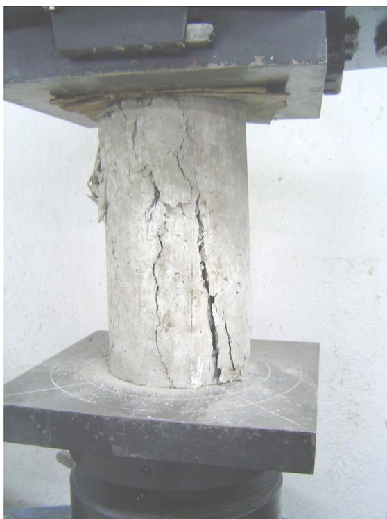
*Fig. 3.3. Imagen de ensayo de rotura de probeta cilíndrica de medidas 15x30 cm. a compresión.*
