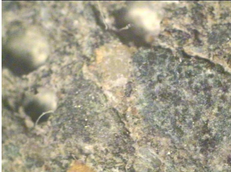
*Fig. 3.71. Imagen mediante microscopio óptico de 200x de cara de probeta de Hormigón tipo con 0,066% de F.P.; 10% H.S. y a/c 0,50 (H.S.F.2-600).*
