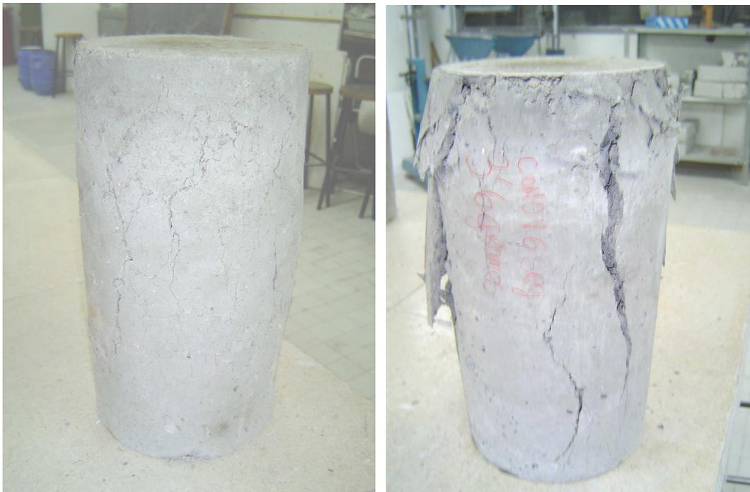
*Fig.3.8. Imagen de probetas con microfibras ensayadas a compresión.*
