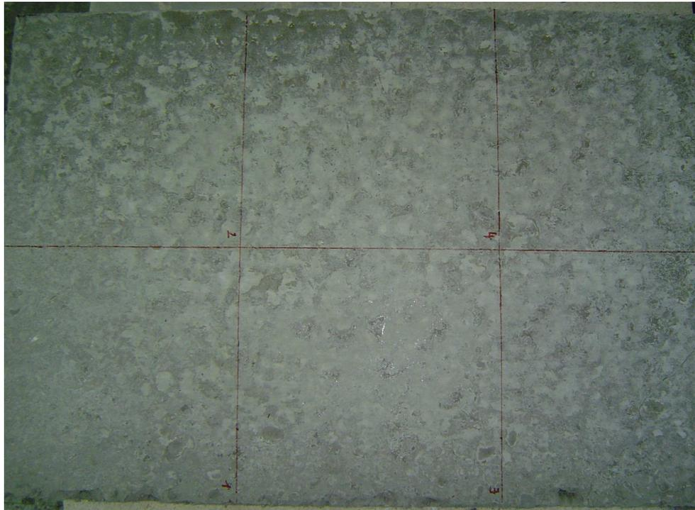
Fig.3.35. Imagen general de losa Kraai para estudio de fisuración en hormigón con adición de microsilice y fibra corta de polipropileno, relación A/C=0,40 (H.S.F.3-600), en la que no se aprecian fisuras.
