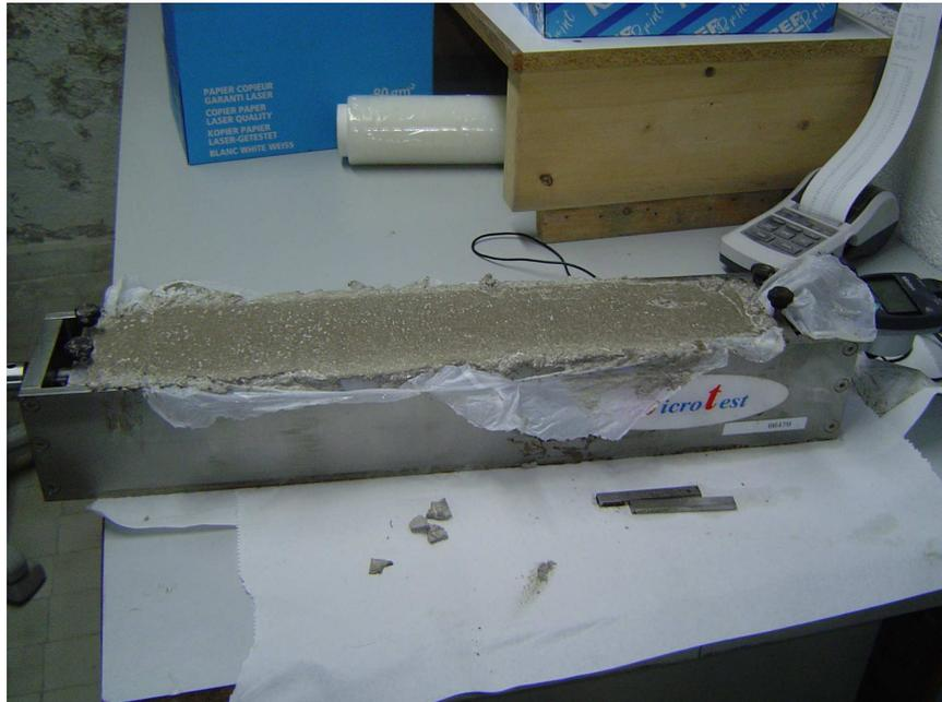
*Fig. 3.46. Vista de instrumental de ensayo de medida de retracción. Se puede observar la bandeja de soporte, el medidor y el receptor de datos.*
