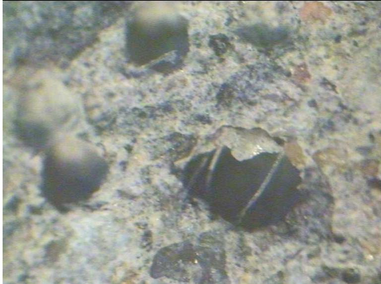
*Fig.3.69. Imagen mediante microscopio óptico de 200x de cara de probeta de Hormigón tipo con 0,099% de F.P. (HT1-900).*
