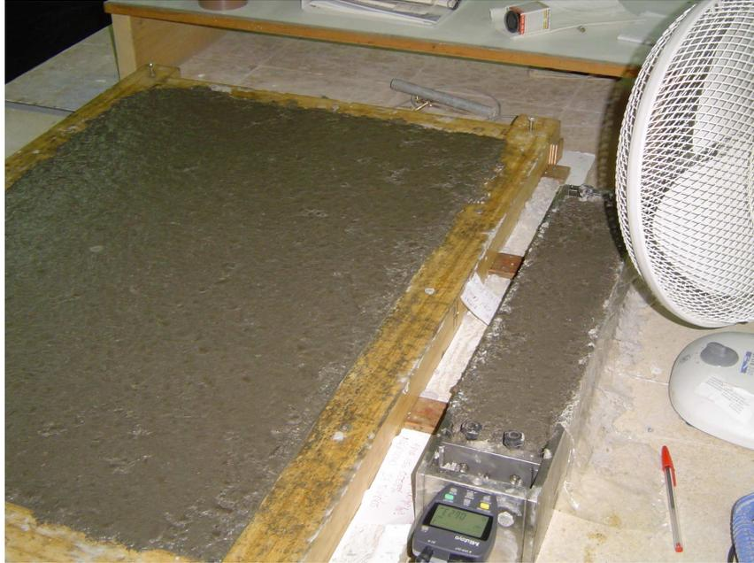
*Fig.3.28. Vista de losa Kraii y de bandeja de retracción, con ventilador durante ensayo efectuado en losa con dosificación de  $0,900 \text{ kg/m}^3$  y 10 % microsíllice sobre peso de cemento, relación a/c 0,55 (H.S.F.2-900).*
