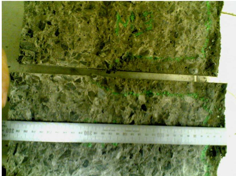
Fig. 3.82. Imagen de probeta ensayada a penetración de agua a presión con fallo de penetración lateral en la serie H.F.2-900.
