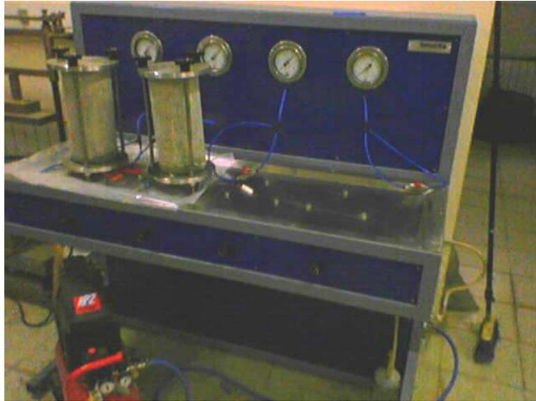
*Fig. 3.59. Imagen de máquina de ensayos para penetración de agua de PAS (Pavimentos Asfálticos Salamanca), vista de compresor y mesa de ensayos con cánulas de fijación.*
