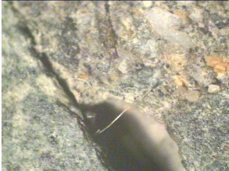
*Fig.3.73. Imagen mediante microscopio óptico de 200x de cara de probeta de Hormigón tipo con 0,066% de F.P.; 10% H.S. y a/c 0,50 (H.S.F.2-600).*
