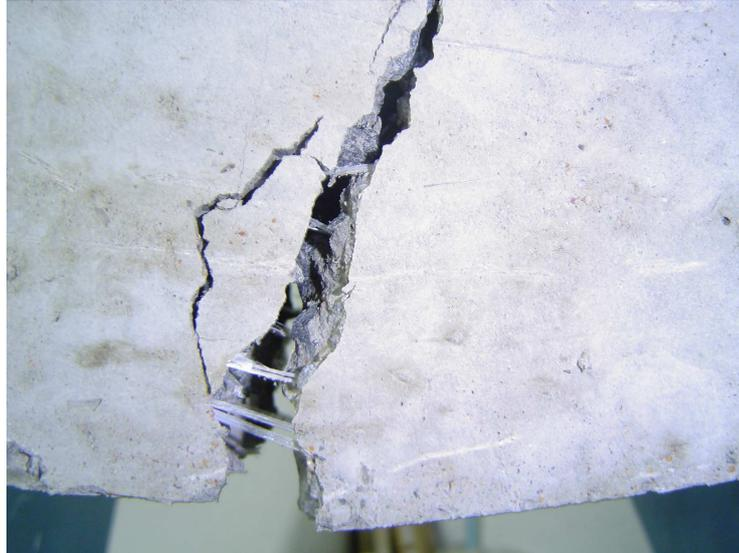
*Figura 2.3. Vista de elemento a flexión de hormigón reforzado con fibra de polipropileno. El trabajo de la fibra se produce en la zona a tracción de la pieza, con mayor tensión en las fibras más alejadas del eje, que sufren una mayor deformación.*
