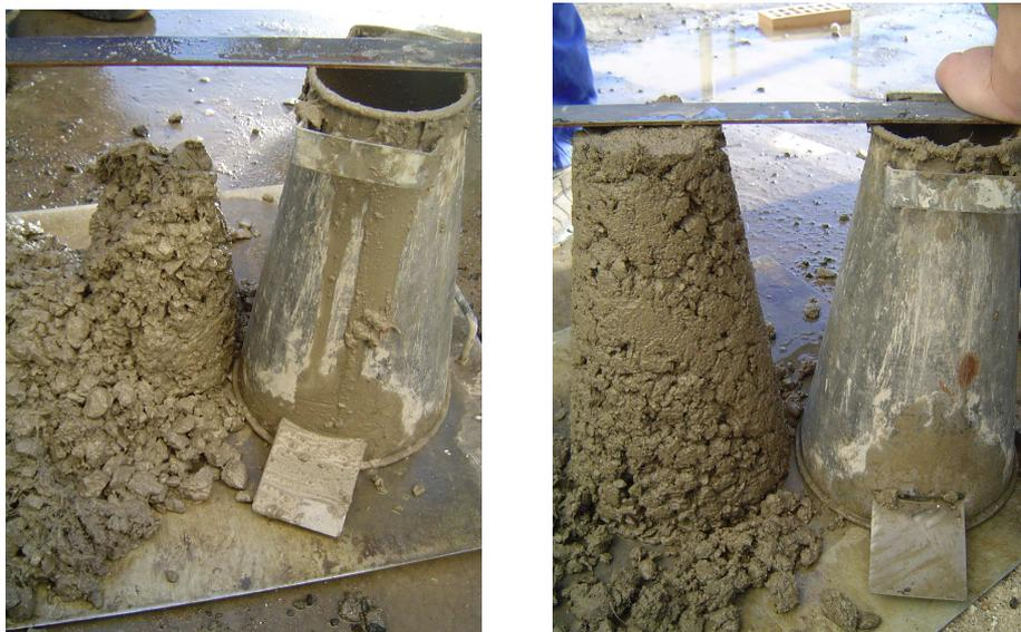
*Figura 2.7. Vista de ensayo en laboratorio de descenso de cono de Abrams de hormigón con fibra para el estudio de la consistencia de las distintas series.*
