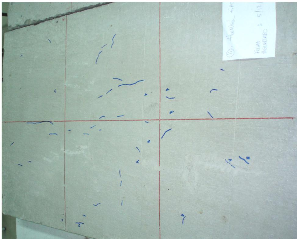
*Fig.3.30. Imagen de losa Kraai hormigón tipo. Vista general de la losa dividida por sectores y re-marcado de las fisuras pasados 24 meses.*
