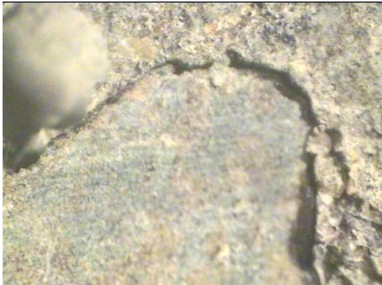
*Fig. 3.74. Imagen mediante microscopio óptico de 200x de cara de probeta de Hormigón tipo con 0,066% de F.P.; 10% H.S. y a/c 0,50 (H.S.F.2-600).*
