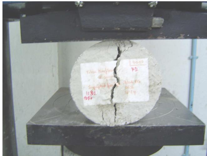
*Fig.3.9. Rotura de probeta cilíndrica de medidas 15x30 cm. dispuesta en horizontal mediante método brasileño en prensa hidráulica.*
