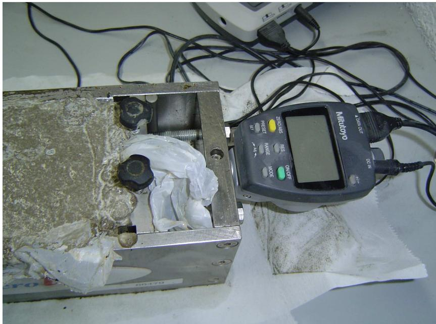
*Fig. 3.47. Vista de instrumental de ensayo de medida de retracción. Imagen cercana del medidor.*
