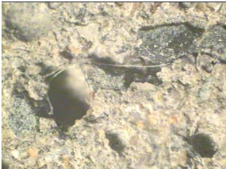
*Fig. 3.77. Imagen mediante microscopio óptico de 200x de cara de probeta de Hormigón tipo con 0,099% de F.P.; 10% H.S. y A/C 0,60 (H.S.F.1-900).*
