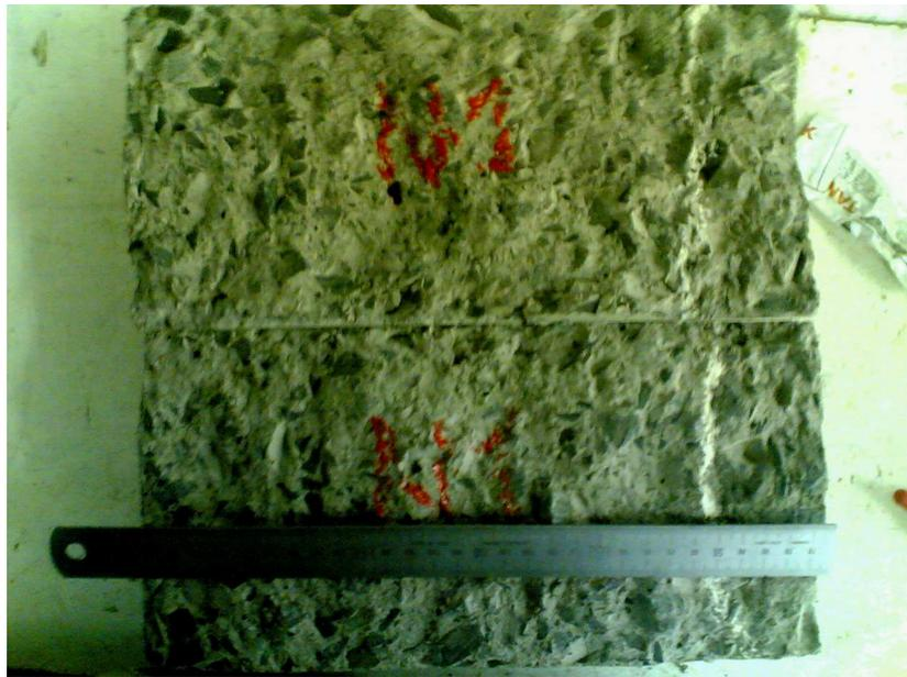
*Fig. 3.88. Imagen de probeta ensayada a penetración de agua a presión con frente de penetración horizontal.*
