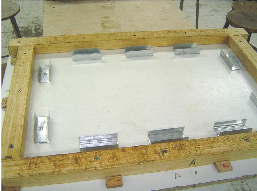
*Fig.3.27. Imagen del molde para la realización de la losa Kraii. Se pueden apreciar las piezas de anclaje en U.*
