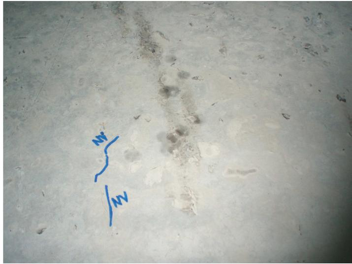
*Fig.3.23. Imagen de la superficie de la probeta de la serie H.S.2-600 ensayada a impacto. En la esta probeta se observó la capacidad de la superficie a deformarse con el impacto antes de fisurar y posteriormente romper.*
