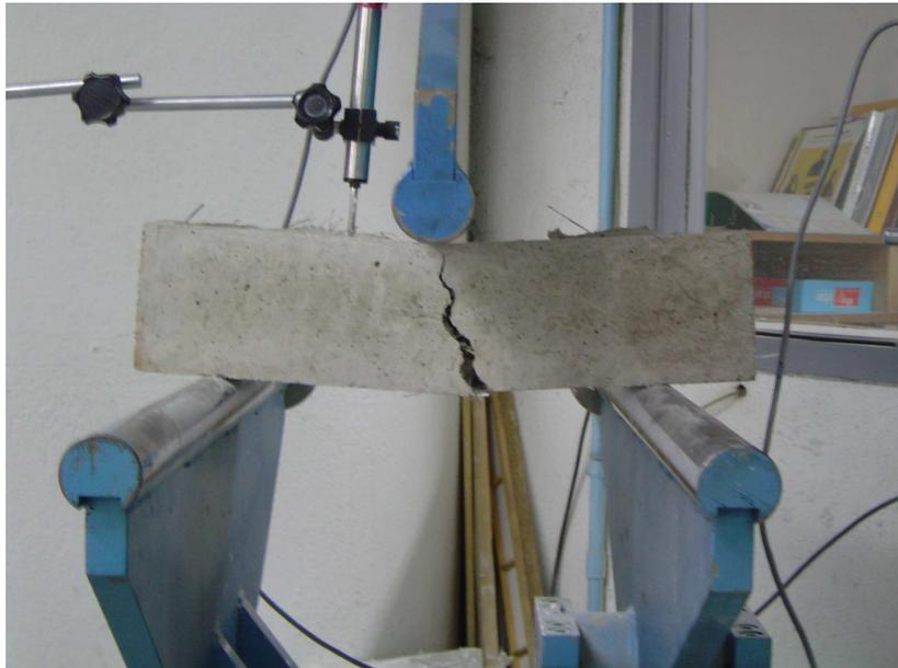
*Figura 3.14. Imagen de rotura de pieza prismática de hormigón tipo de 15x15x45 cm<sup>3</sup>.
