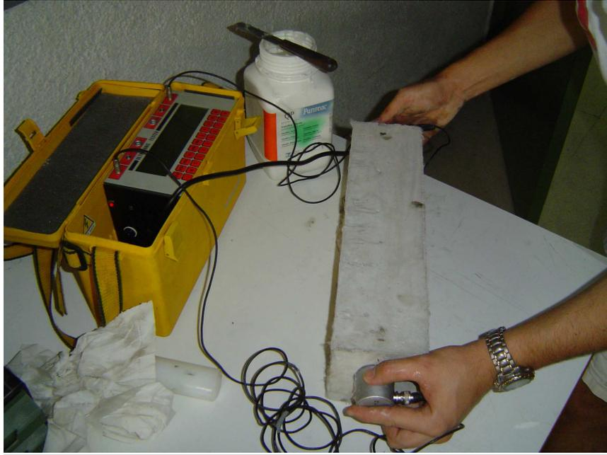
*Fig.3.58. Imagen de equipo de medida de ultrasonidos usado en probeta prismática.*
