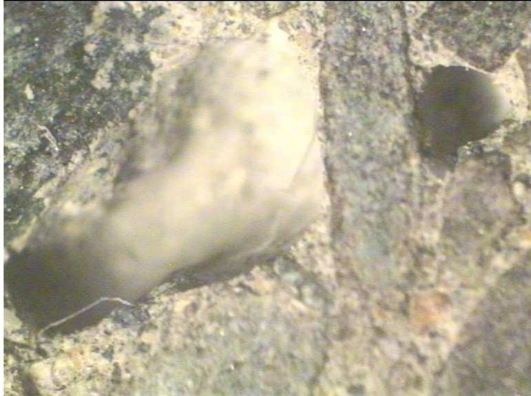
*Fig. 3.76. Imagen mediante microscopio óptico de 200x de cara de probeta de Hormigón tipo con 0,099% de F.P.; 10% H.S. y A/C 0,60 (H.S.F.1-900).*
