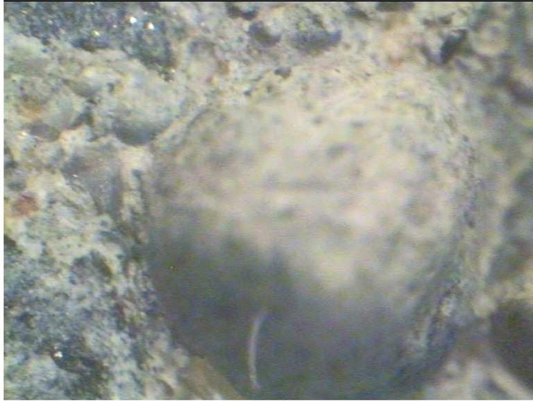
*Fig. 3.68. Imagen mediante microscopio óptico de 200x de cara de probeta de Hormigón tipo con 0,099% de F.P. (HT1-900).*
