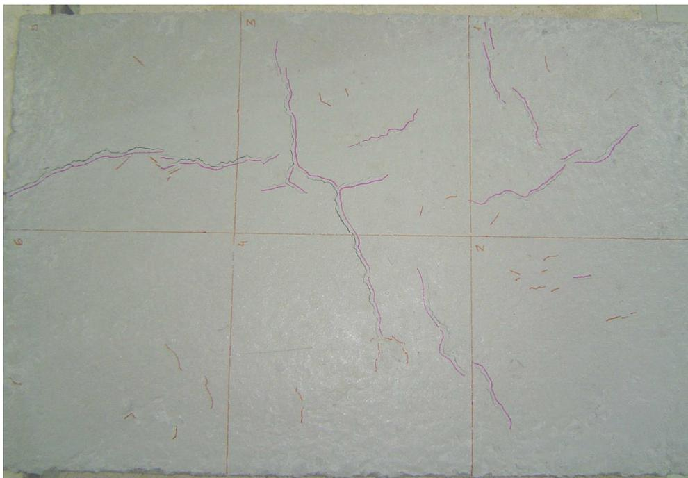
*Fig.3.33. Imagen general de losa Kraai para estudio de fisuración en hormigón tipo con adición de microsílíce en un 10% de sustitución de cemento (H.S.1).*
