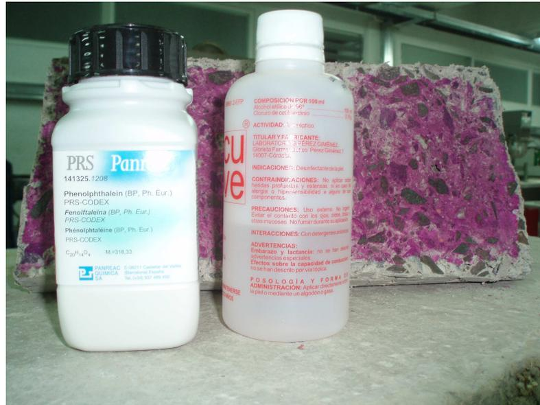
*Fig. 3.92. Imagen de indicador de pH y etileno con probeta fragmentada a ensayo brasileño y posteriormente rociada con disolución de fenoftaleina.*
