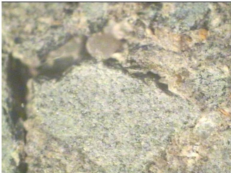
*Fig.3.72. Imagen mediante microscopio óptico de 200x de cara de probeta de Hormigón tipo con 0,066% de F.P.; 10% H.S. y a/c 0,50 (H.S.F.2-600).*
