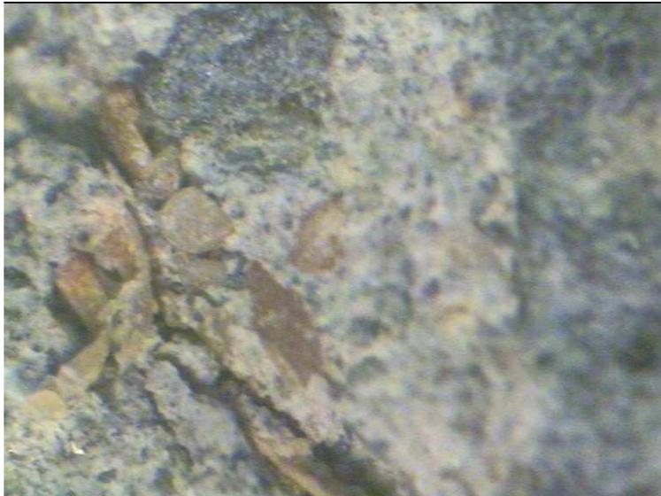
*Fig. 3.65. Imagen mediante microscopio óptico de 200x de cara de probeta de Hormigón tipo (HT1), obtenida mediante corte con circular en la que se aprecia el interior de la misma.*
