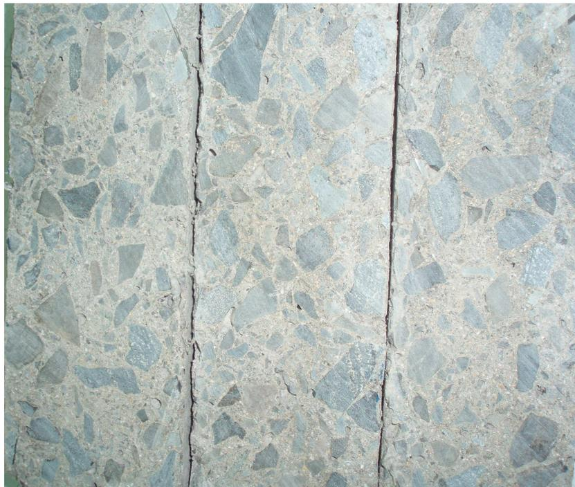
*Fig. 3.75. Imagen mediante cámara digital 3x de cara de probeta de Hormigón tipo con 0,099% de F.P. Y 10% H.S. con relación A/C 0,6 (H.S.F.1-900).*
