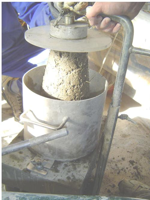
*Fig. 3.2. Imagen del consistómetro Vebe con probeta para su ensayo posterior.*
