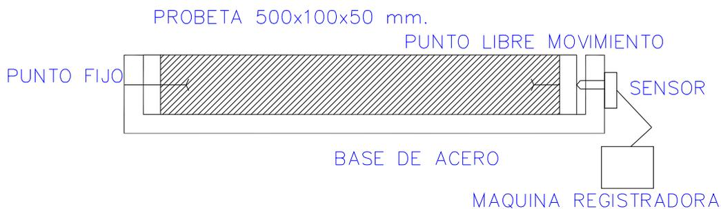
*Fig.3.45. Esquema de la base para el ensayo de retracción en los hormigones avanzados canarios.*
