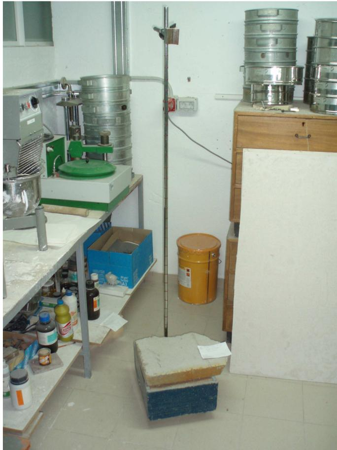
*Fig.3.20. Imagen de plataforma de ensayo para resistencia a impactos de losas de hormigón.*
