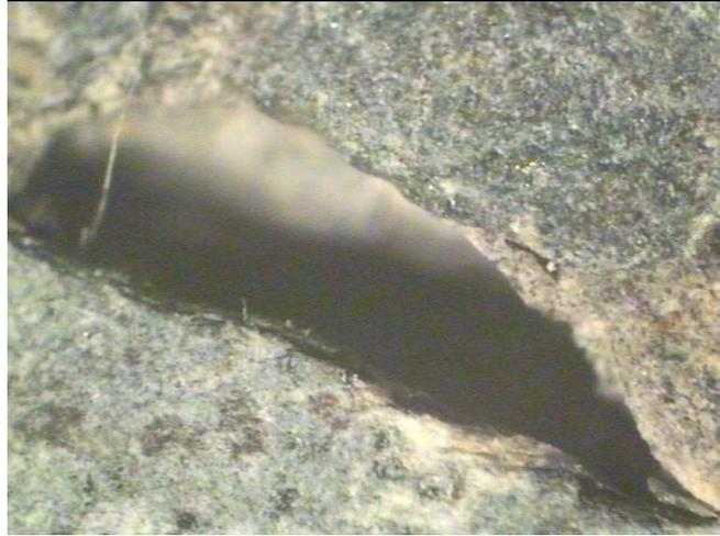
*Fig. 2.28. Imagen obtenida mediante microscopio óptico de 200 x de bordes de áridos y poro generado por la propia geometría de éste.*
