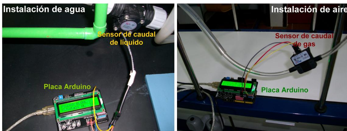
Figura 1. Detalles de sensores de caudal electrónicos y su conexión a la placa Arduino con módulo de pantalla.
