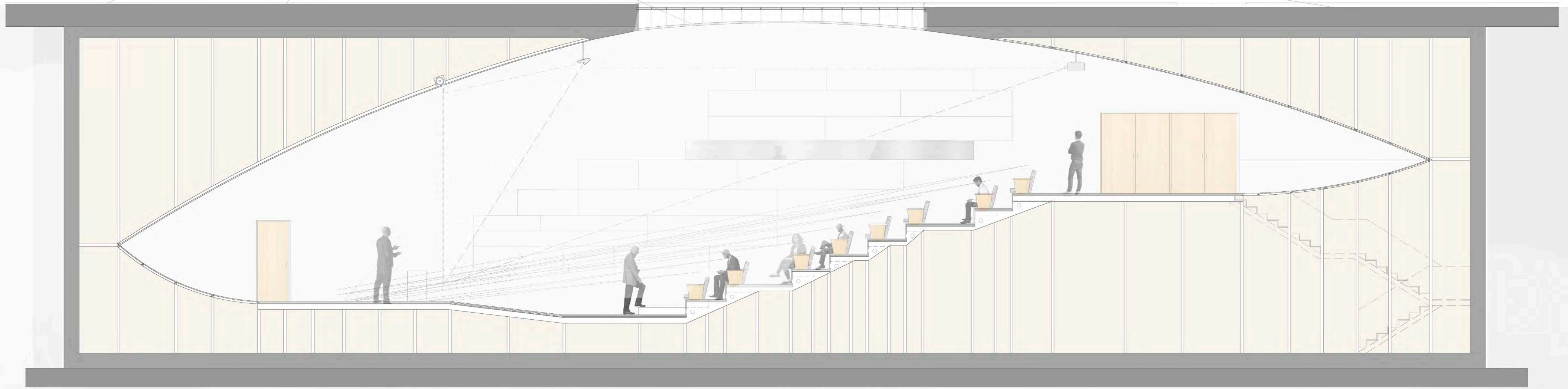
Sección longitudinal sala de conferencias e 1:75
