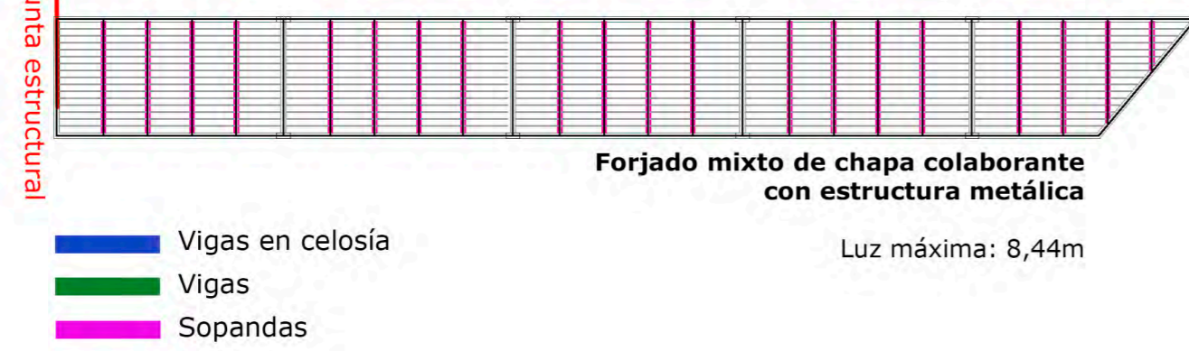
Planta de forjado de la pasarela +75m e 1:250
