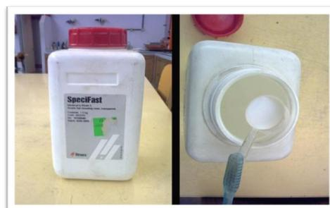
**Ilustración 51. Resina de montaje utilizada en el taller para el encapsulamiento de nuestras muestras, Struers.**
