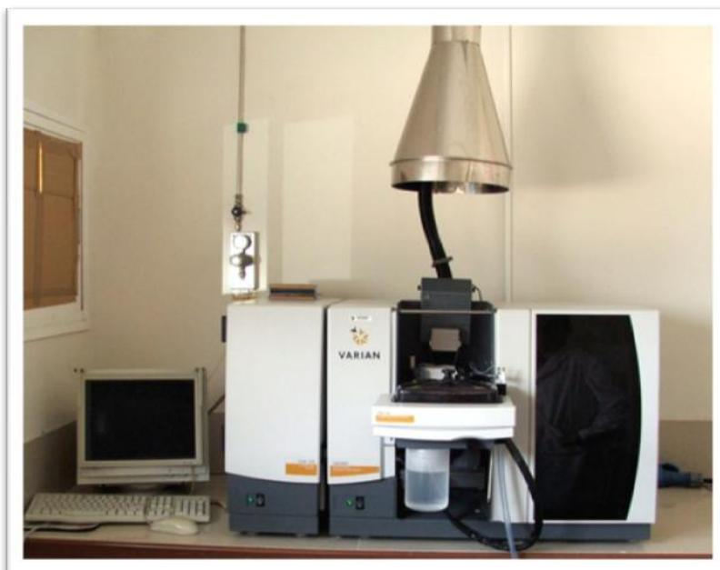
Ilustración 12. Espectrofotómetro de absorción atómica VARIAN AA-240Z con corrección de fondo Zeeman y con cámara de grafito modelo GTA-120.
