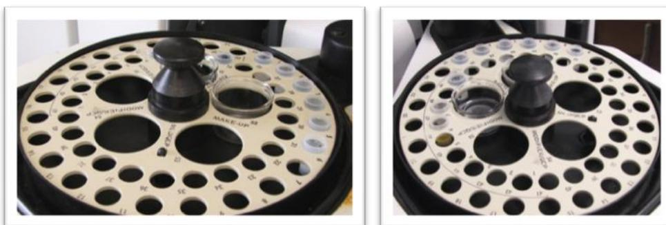
**Ilustración 83. Posiciones en el inyector automático PSD-120.**
