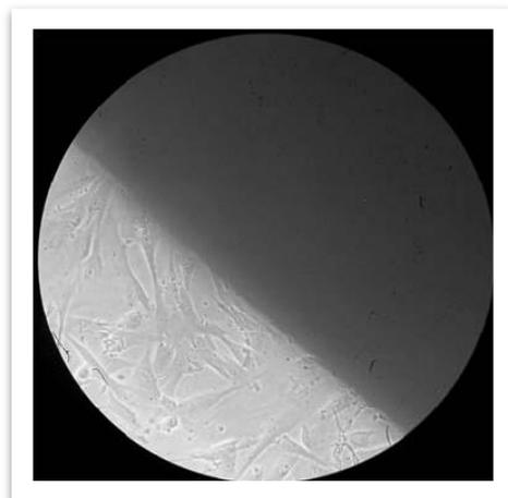
**Ilustración 19.** Interfaz de una muestra inmersa en SBF después de 5 días; células observadas en contraste-fase.
