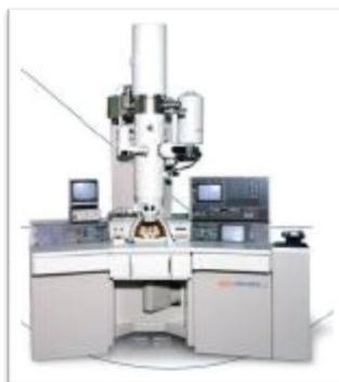
Ilustración 92. Microscopio electrónico de transmisión.
