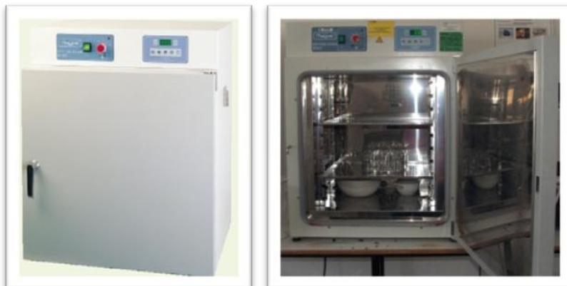
**Ilustración 8. Estufa digital de secado y esterilización modelo RAYPA DRYING OVEN DIGIT, DOD-20.**
