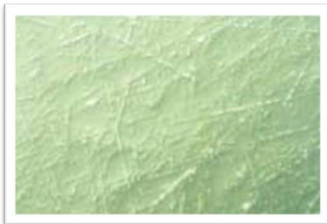
Ilustración 55. Aum 200x. Líneas de deformación afiladas. Metalog guide Struers.
