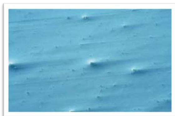
Ilustración 59. Aum 200x. Colas de cometa. Metalog guide Struers.
