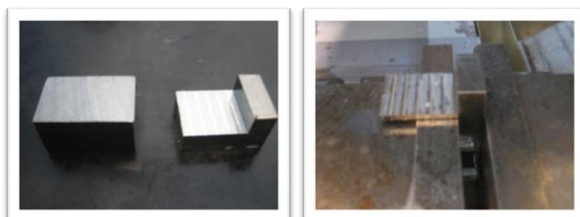
Ilustración 24. Primera fase terminada y mecanizado de la segunda cara.
