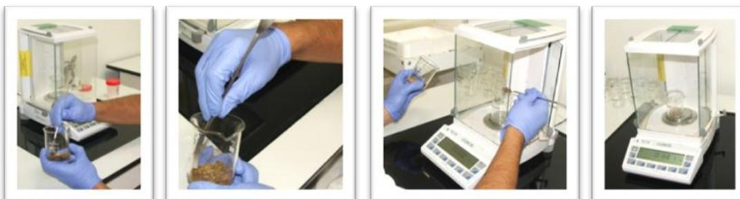
Ilustración 78. Proceso de tarado de la muestra seca.
