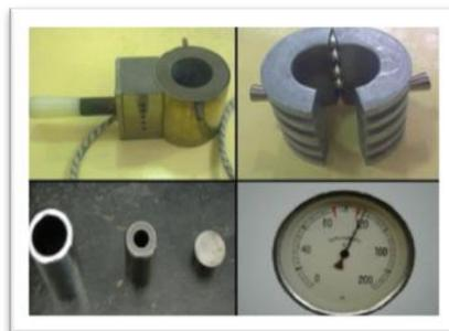
Ilustración 3. Calefactor, Refrigerador, Cilindros de montaje y termómetro utilizado en la prensa del laboratorio.
