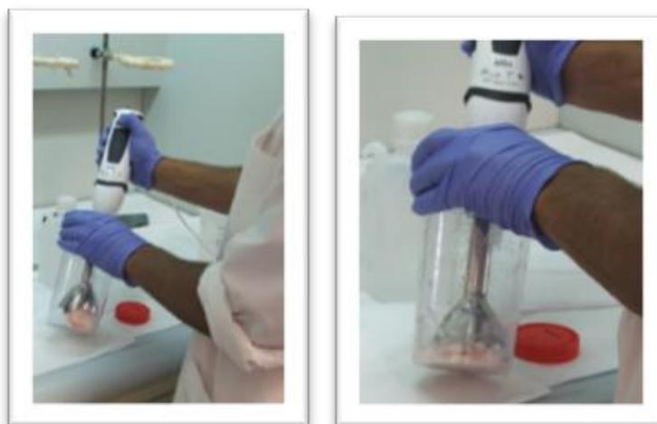
Ilustración 73. Proceso de triturado de la muestra.
