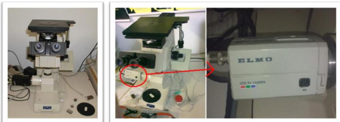
Ilustración 5. Microscopio metalográfico utilizado y la cámara incorporada.
