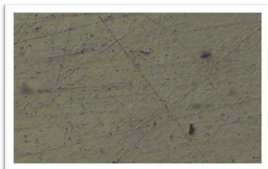
**Ilustración 62.** Defectos superficiales en una muestra de Ag-Pd de partículas abrasivas tras el lapeado 600x.
