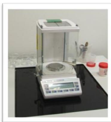
Ilustración 7. Balanza analítica modelo COBOS XT 220A.
