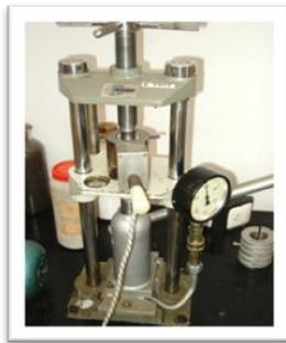
Ilustración 2. Máquina empastilladora.
