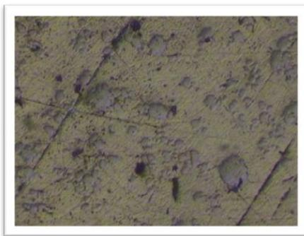
**Ilustración 61.** Defecto superficial donde se aprecian una serie de inclusiones en una muestra de Ag-Pd. 600x.
