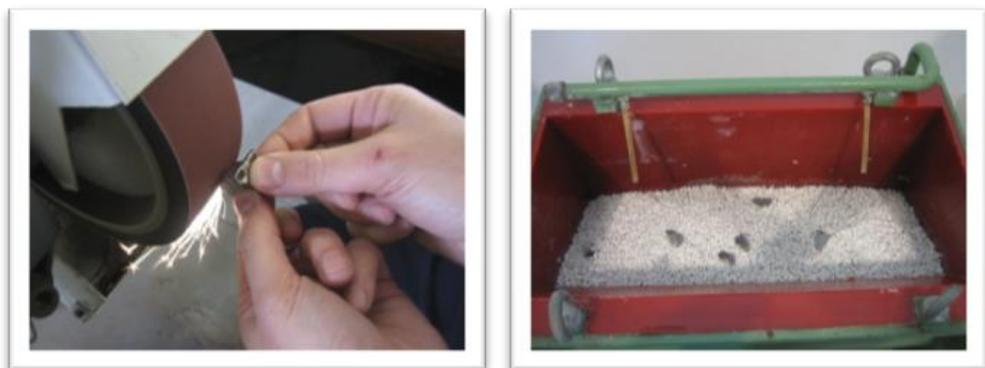
Ilustración 27. Acabado superficial: Pulido y vibradora.
