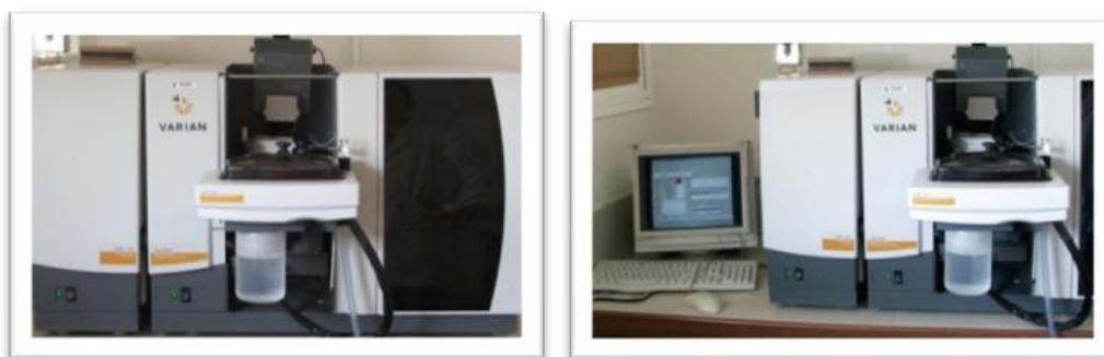
Ilustración 81. Espectrofotómetro Varian AA 240Z con horno de grafito GTA-120 e inyector automático PSD-120.
