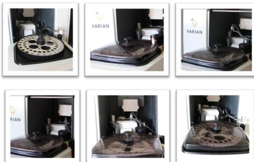
Ilustración 86. Proceso de inyección de muestras con el inyector automático PSD-120.
