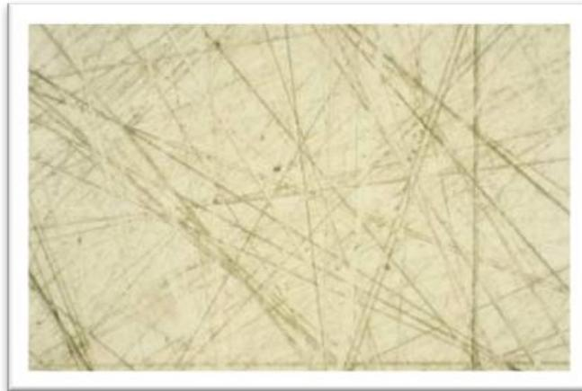
Ilustración 54. Aum 200 x. Rayas producidas tras el pulido fino. Metalog guide Struers.
