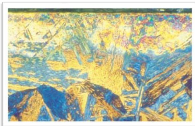
**Ilustración 57. Aum 100 x. Separación entre la resina y la muestra. Metalog guide Struers.**
