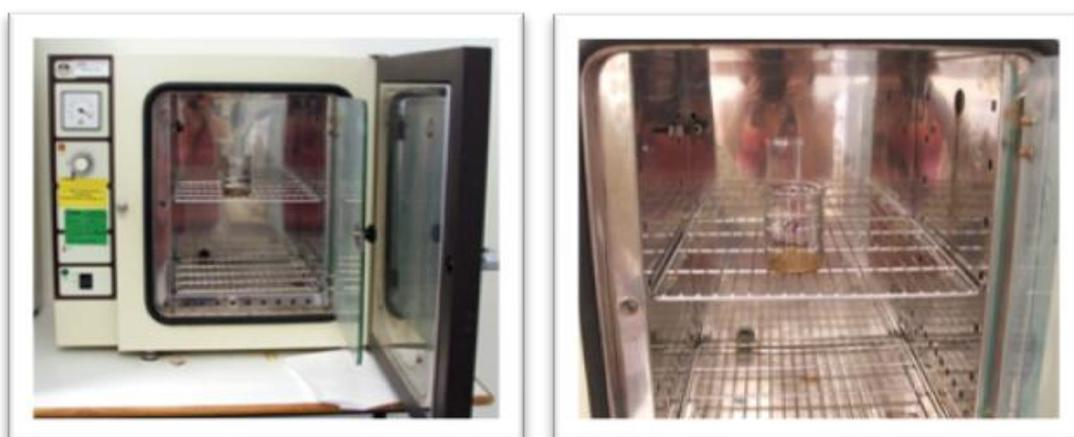
Ilustración 76. Proceso de secado de la muestra.
