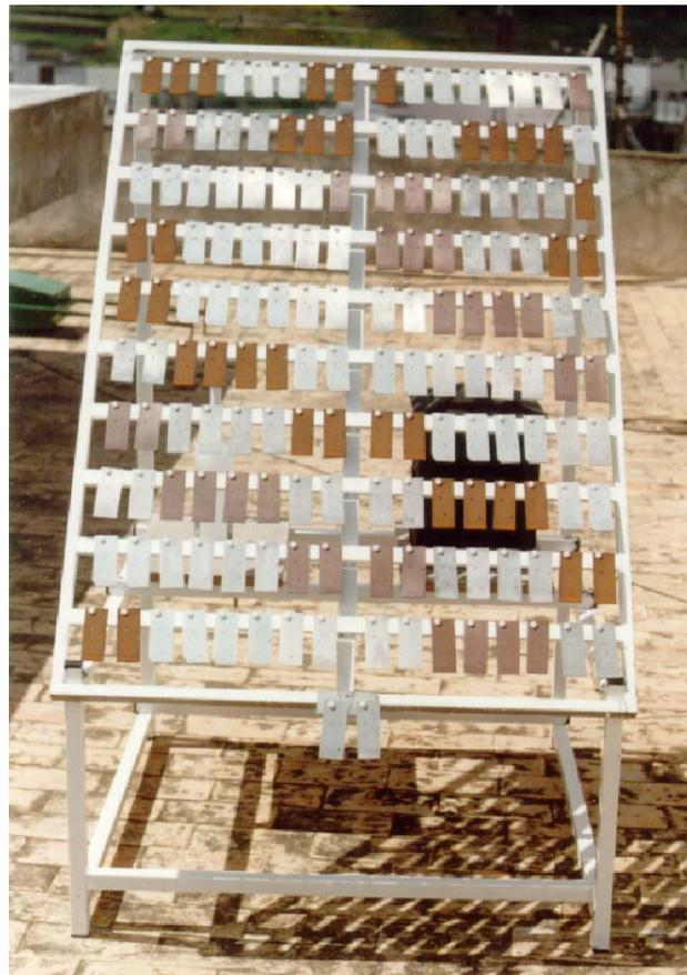
**Figura 3.4.-** Vista frontal de la estructura metálica y de las probetas objeto de estudio.
