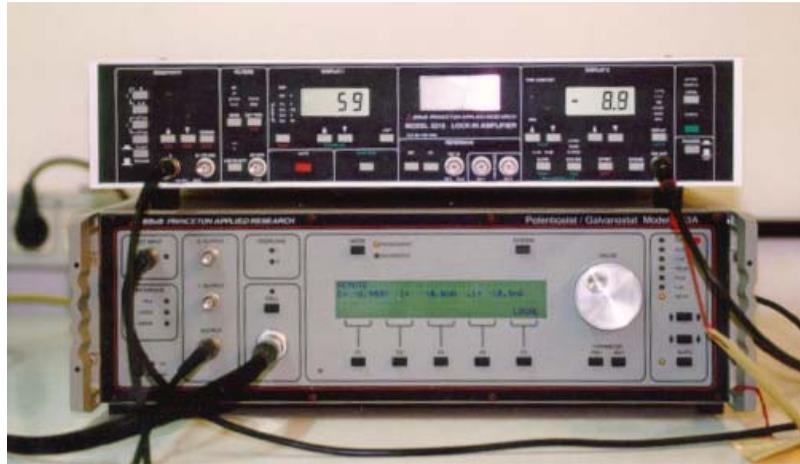
**Figura 3.10.-** Potencióstato/Galvanostato EG&G
