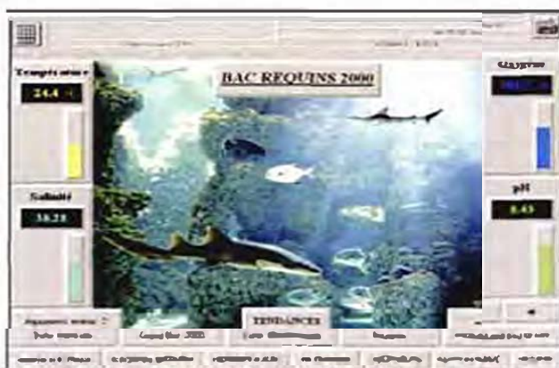
Figura 73. Pantalla de control de parámetros de la GTC. Compartimento Grandes Demersales
