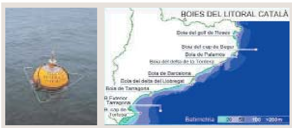
Figura 5.6.6. Descripción del sistema de boyas de clima marítimo del litoral catalán
