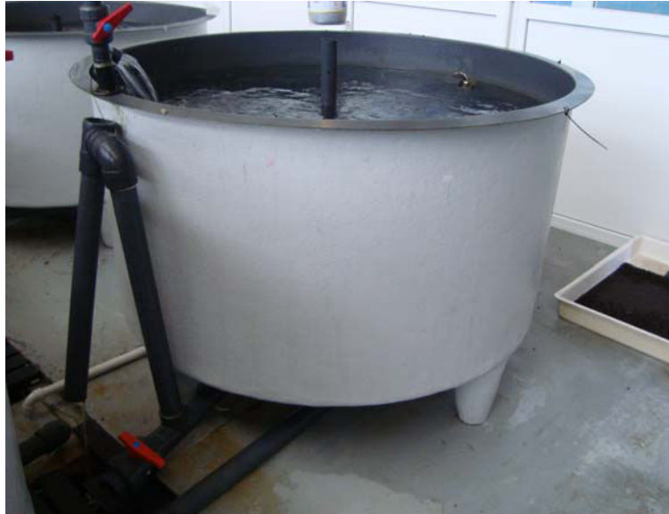
Figura 2.1: Tanque de aclimatación de 1000 l
