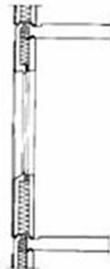
Paneles de cerramiento prefabricados de hormigón.
