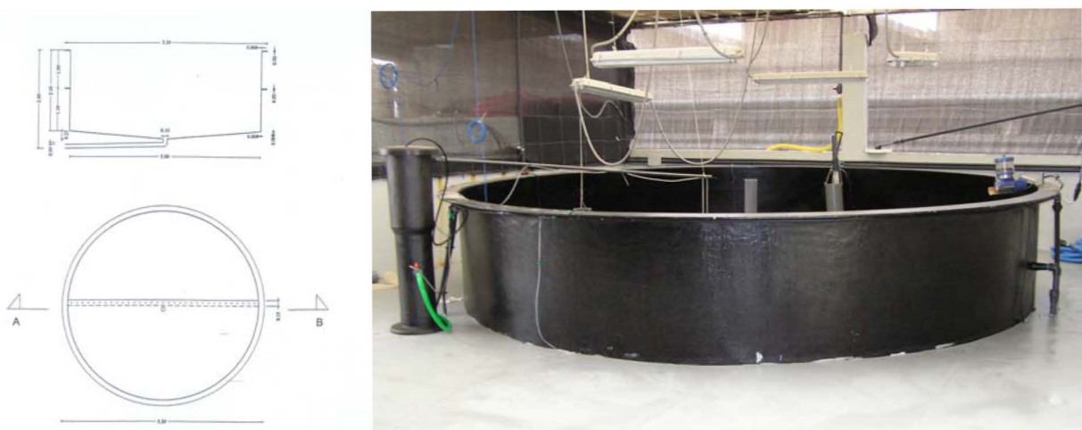
Figura 22. a) Vista longitudinal, planta del tanque; b) Tanque de cultivo semi-intensivo.
