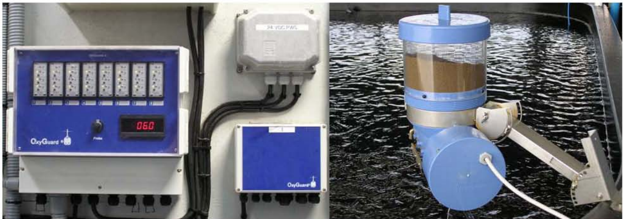
Figura 47. a) Sistema de control de oxígeno disuelto; b) Alimentador automático.
