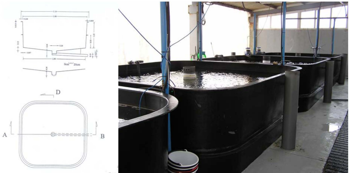
Figura 27. a) Vista longitudinal, planta y fotografía de tanques de alevinaje.
