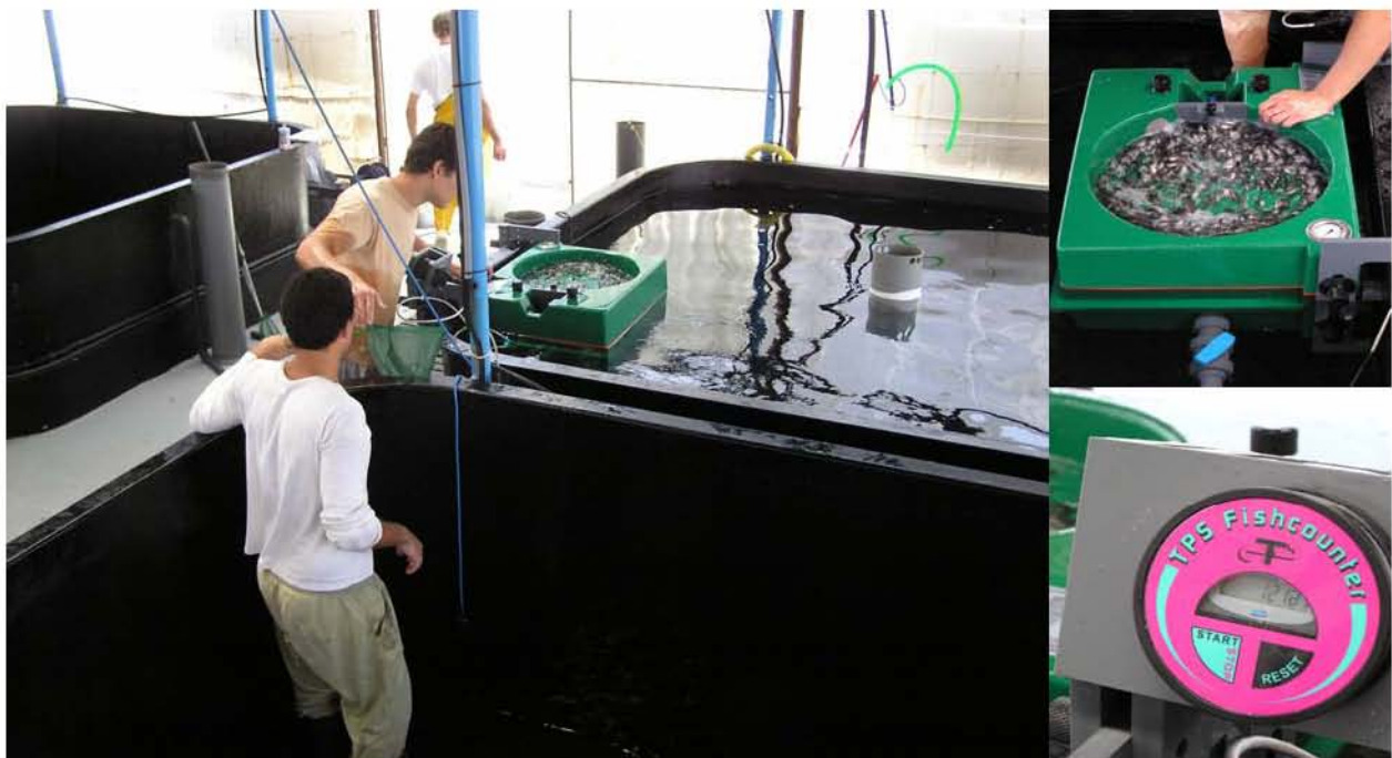
Figura 50. a) Operación de conteo de alevines. c,d) Detalle de contador industrial de alevines TPS Fishcounter.
