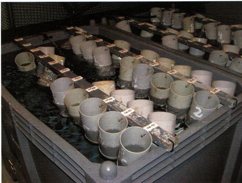
Fig. 13.- Tanques de 500 l con los cubiletes de PVC en su interior.
