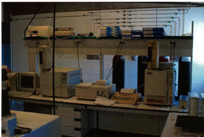
Fig. 18.- Cromatógrafo de gases utilizado para la determinación de los ácidos grasos.
