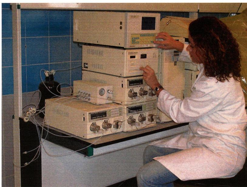
Fig. 19.- HPLC utilizado para la determinación de la vitamina E.
