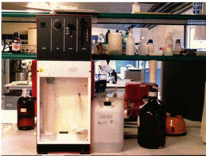
Fig. 16.- Unidad de destilación para proteínas.
