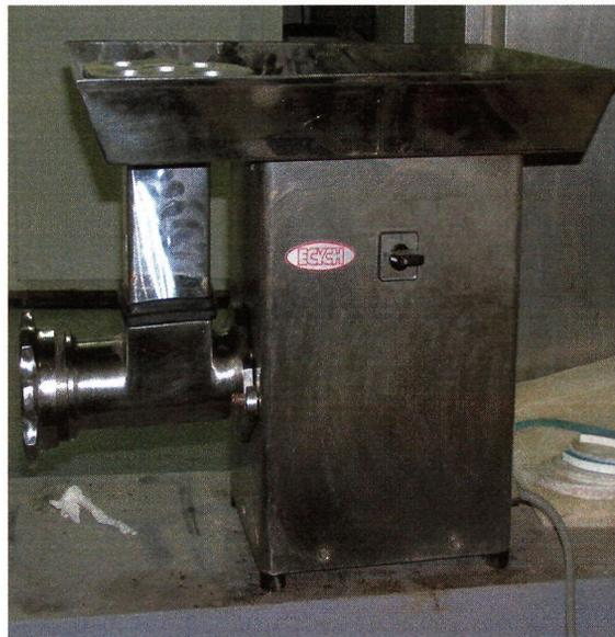
Fig. 21.-Granuladora utilizada para elaborar los gránulos de las dietas de los Experimentos I y II.
