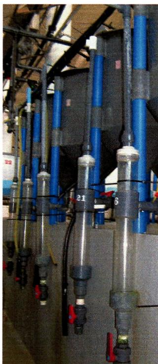
Fig. 6.- Tanques usados para determinar la digestibilidad de las harinas utilizadas en el Experimento II, se observan las columnas de decantación.
