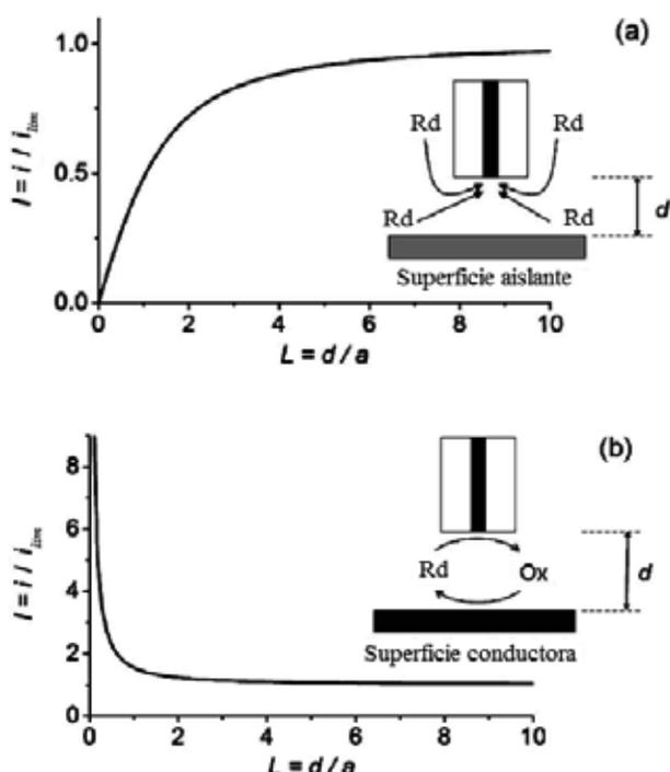
**Figura 2** - Variación de la corriente normalizada  $I$  con la distancia normalizada  $L$  para: (a) una superficie aislante con respuesta de retroalimentación negativa, y (b) una superficie conductora con respuesta de retroalimentación positiva.
