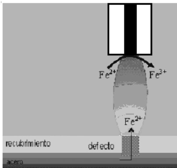
**Figura 5** – Representación esquemática del UME de un SECM trabajando en el modo generador-recolector para registrar la actividad electroquímica que se produce en un defecto artificial realizado en acero galvanizado recubierto con un polímero orgánico.
