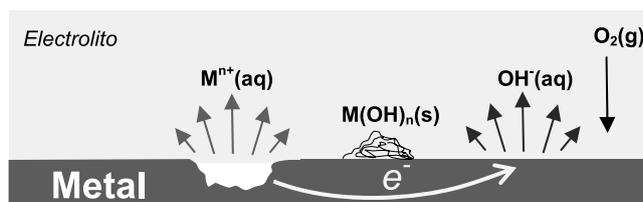
**Figura 4** - Esquema del proceso corrosivo que tiene lugar sobre un metal sumergido en un electrolito neutro. Se produce una difusión de iones desde la zona catódica y anódica hacia el seno de la disolución.
