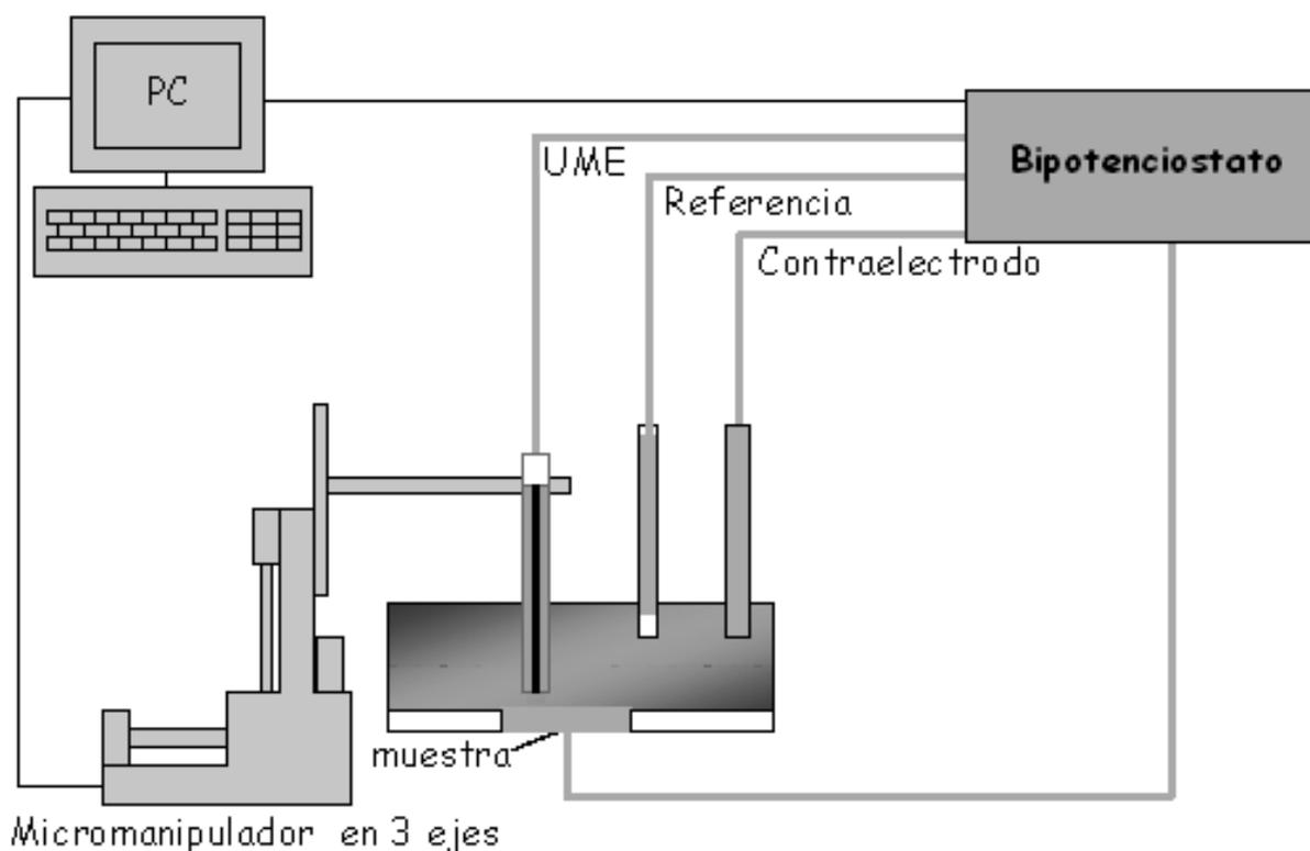
Figura 1 - Esquema típico del dispositivo experimental para SECM.
