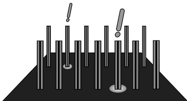
**Figura 8** – Detección de picaduras metaestables en acero inoxidable 304 expuesto a HCl 0.5 M. Se mide una corriente en el UME cuando pasa por encima de una picadura metaestable, mientras que el resto de la superficie se encuentra en el régimen de pasividad.
