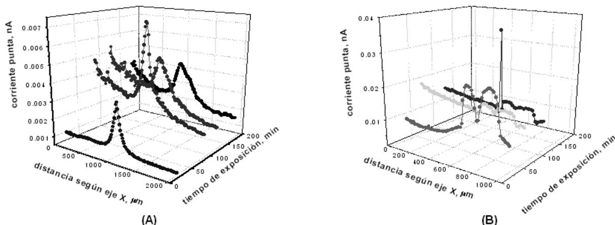
**Figura 6** – Líneas de los barridos SECM a través de un defecto provocado en una muestra de acero recubierto con poliuretano, después de su inmersión en una disolución (A) 0.1 M en KCl, y (B) 0.1 M en  $Na_2B_4O_7$ . El potencial del UME fue +0.60 V vs. Ag/AgCl/KCl (saturado), y la distancia entre el sustrato y el UME: 10  $\mu m$ .
