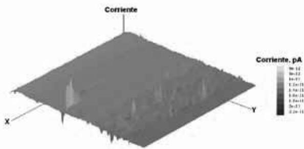
**Figura 7** – Imagen SECM para un acero inoxidable 304 expuesto a HCl 0.5 M mientras que se encuentra en su potencial espontáneo de corrosión. El mapa representa un área de 400  $\mu\text{m}$  x 400  $\mu\text{m}$  en las direcciones X e Y. Potencial del microelectrodo: +0.50 V vs. Ag/AgCl/KCl (sat.); distancia UME-muestra: 10  $\mu\text{m}$ . La corriente de fondo se ha tomado como cero.
