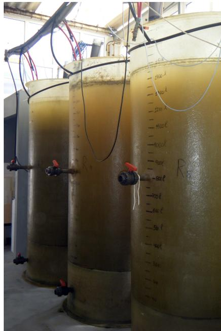
**Fig.21.- Tanques de producción de rotíferos.**
