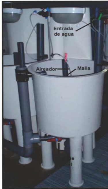
Fig.4.3.2 .Tanque de la sala de larvario provisto de entrada de agua, desagüe central, malla y aireador.
