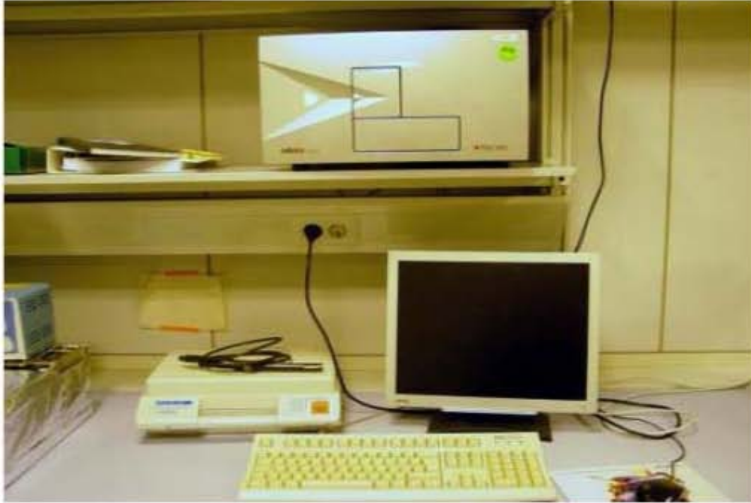
Fig.4.3.3.6.2. Espectrofotómetro (Synergy HT, Bio-Tek) utilizado para la cuantificación de las enzimas pancreáticas y intestinales.
