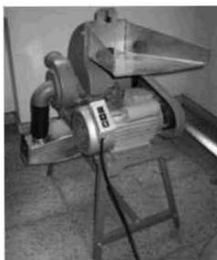
Figura 1. Molino de cuchillas
