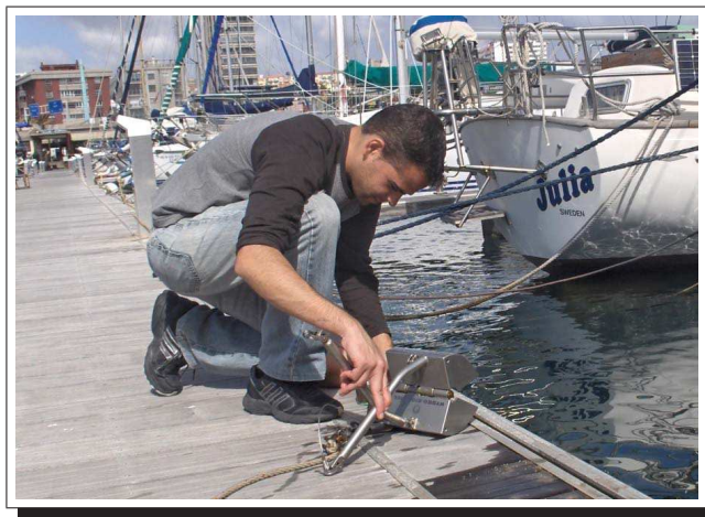
Figura 5.5 .- Recolección de sedimentos con una draga Van Veen.
