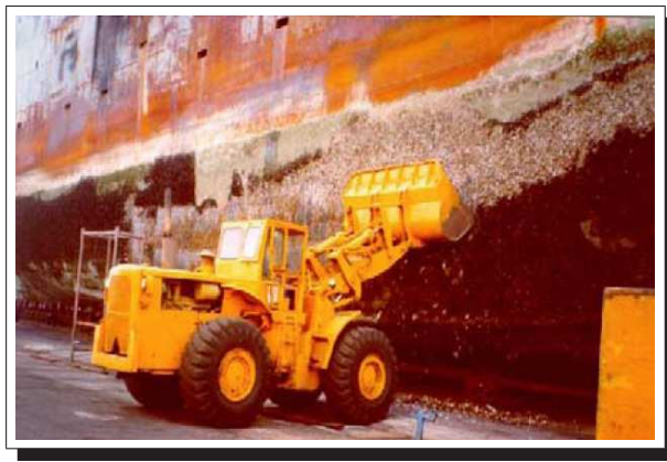
Figura 1.1 .- Casco de un barco afectado por bioincrustaciones (extraído de la referencia [1]).
