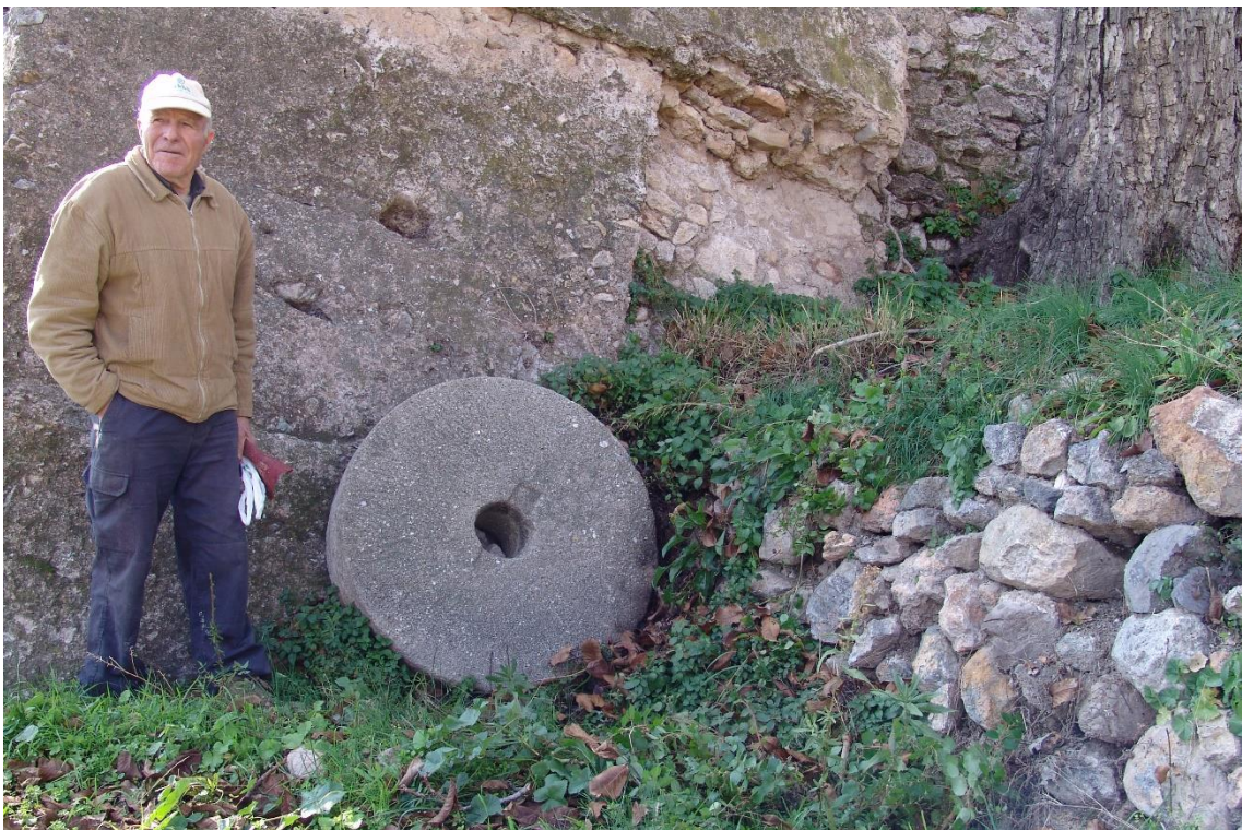
Fotografía 8.112: en el frontis del primer molino de agua del Valle de Huebro, se observa coyunturalmente una muela volandera. Estas otras muelas giran sobre las soleras. Captura del 29 de diciembre de 2007
