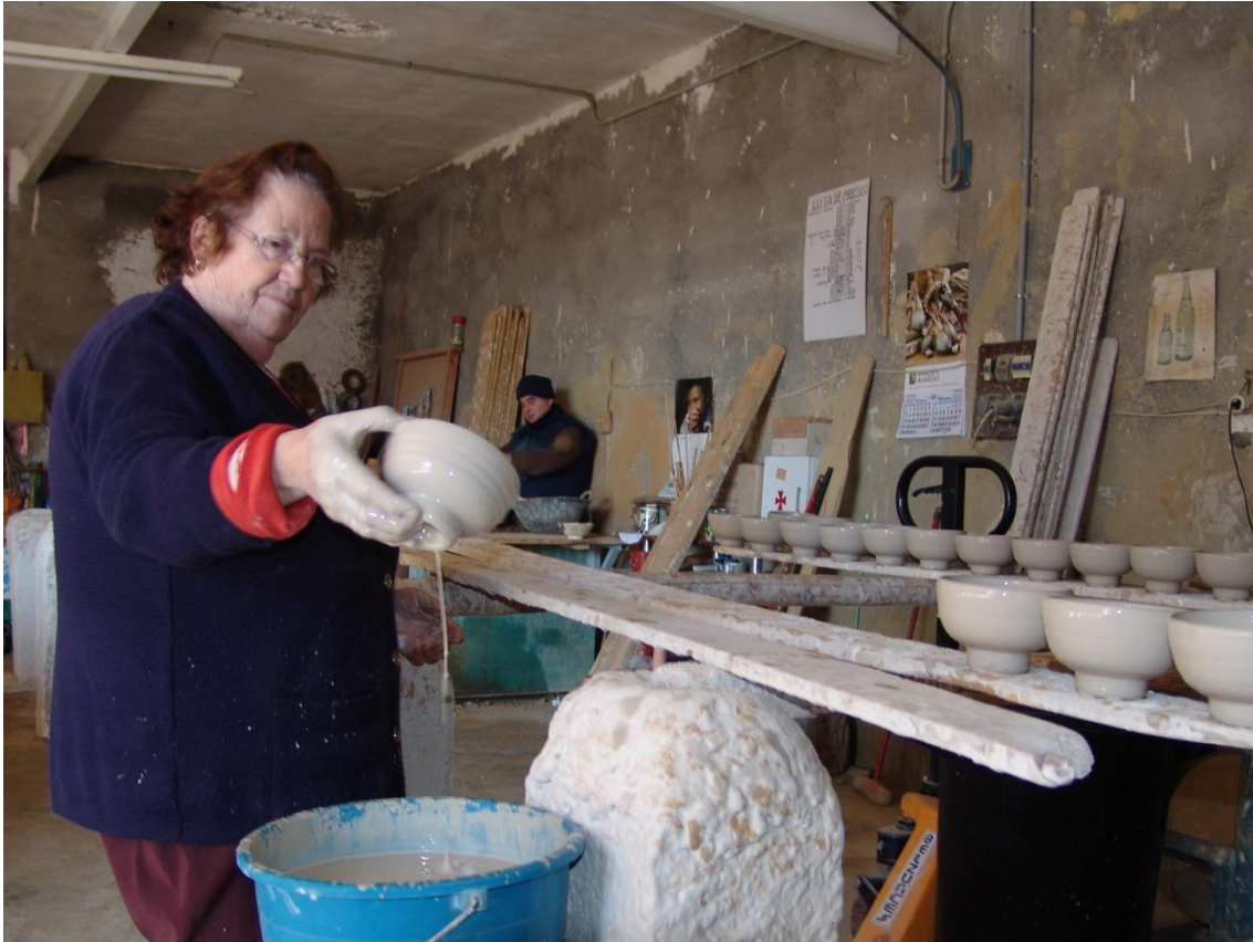
Fotografía 6.14: labores de baño en una lechada de caolín, en la alfarería de Granados García, en la Calle Real de las Eras, número 104, de la Villa de Níjar. Captura del 29 de diciembre de 2007
