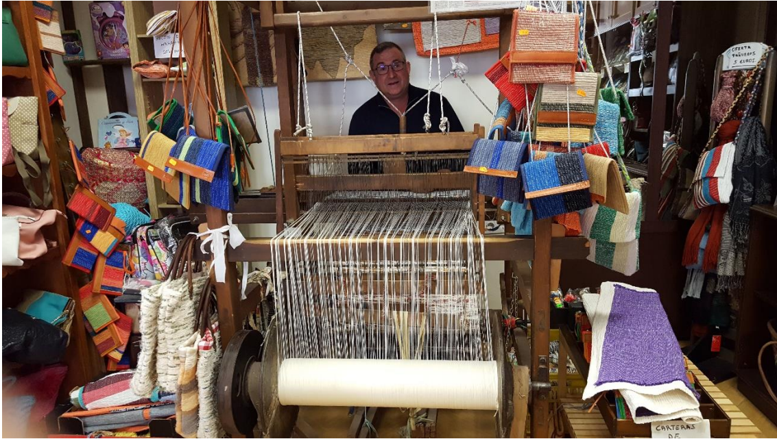
Fotografía 6.31: vista frontal del telar para la demostración de la fabricación de jarapas, en la Oficina de Información de la Junta de Andalucía ubicada en Níjar (Almería), sita en la Plaza García Blanes. En un primer plano, se observa los hilos que forman la urdimbre en la que se entrelaza las tiras de trapos viejos (harapos), para fabricar una jarapa. Captura del 1 de mayo de 2017
